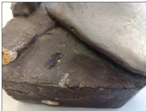
Slika 83. Postavljeni agar gel na površinu postolja u svrhu utvrđivanja pH površine, fotografirala: S. Knežević, studeni 2023.
