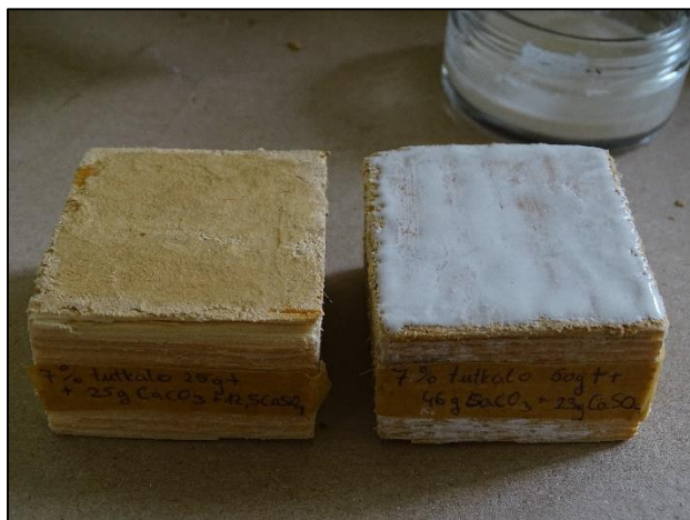
Slika 159. Testne pločice, lijeva s slojem Grilith Holzkitt kita za drvo i izolacijskog sloja i izolacijskim otopinom Planatola BB i vodom u omjeru 1:5, desna pločica nanesen sloj 7%-tne kredno-tutkalne osnove , fotografirala: S. Knežević, lipanj 2024.
