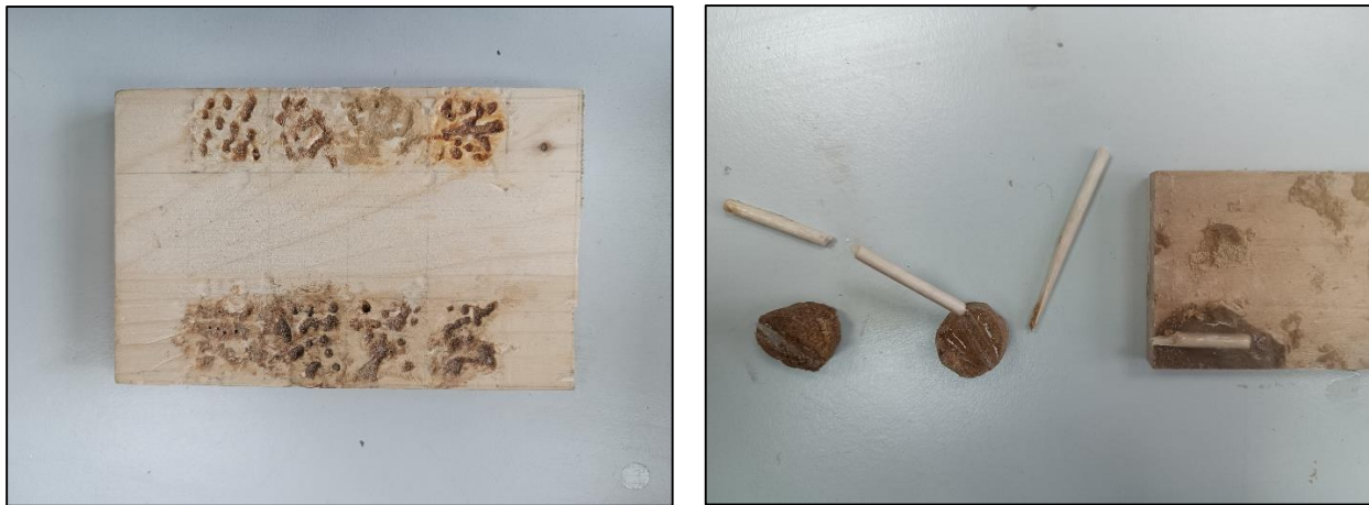
Slike 119.-120. Probe različitih kitova za nadoknadu u sloju nosioca na testnoj pločici, Proba kompatibilnosti kita na bazi Drvofix i kita na bazi K9 sa Bison Epoxy 5 min ljepilom, fotografirala: S. Knežević, ožujak 2024.
