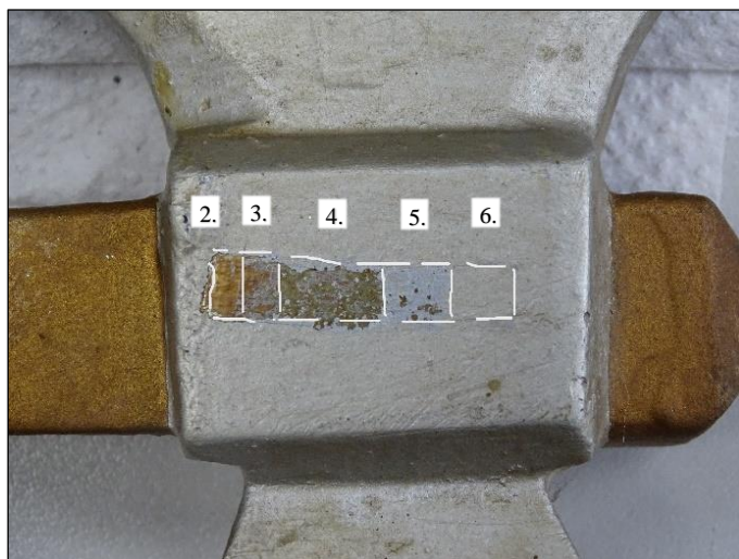
Slika 60. Sonda 5. Stratigrafski slojevi na sječivu sjekire, fotografirala: S. Knežević, prosinac 2023., (broj na slici prati tehnološke slojeva u tablici 5 )
