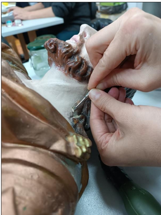
Slika 76. Uzimanje uzorka stratigrafskih slojeva inkarnata s područja vrata, fotografirala: S. Knežević, prosinac 2023.
