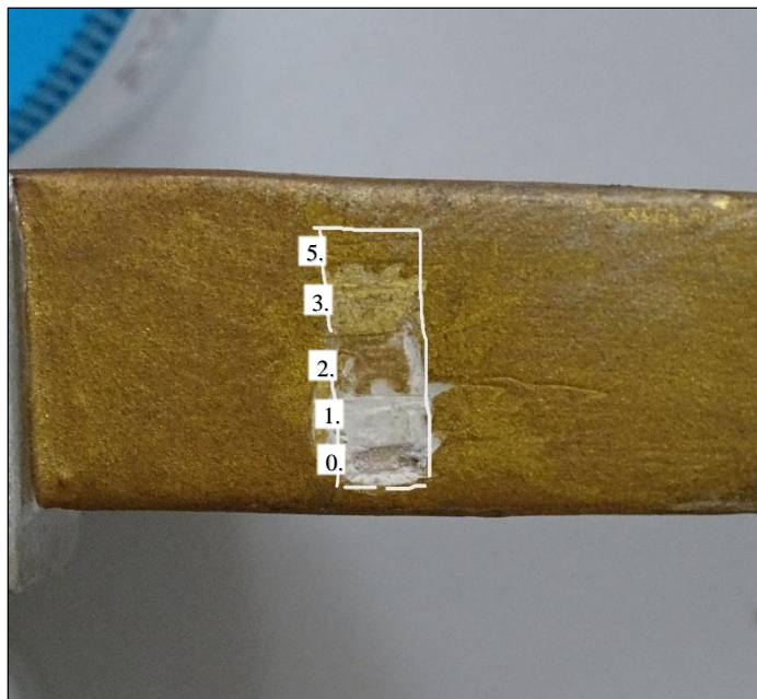
Slika 59. Sonda 4. Stratigrafski slojevi na dršci sjekire, fotografirala: S. Knežević, prosinac 2023., (broj na slici prati tehnološke slojeva u tablici 4 )
