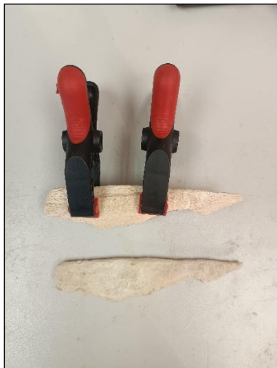
Slika 153. Spajanje dviju letvica PVAc Bizon Wood glue D2 ljepljom u jednu cjelinu, fotografirala: S. Knežević, svibnja 2023.
