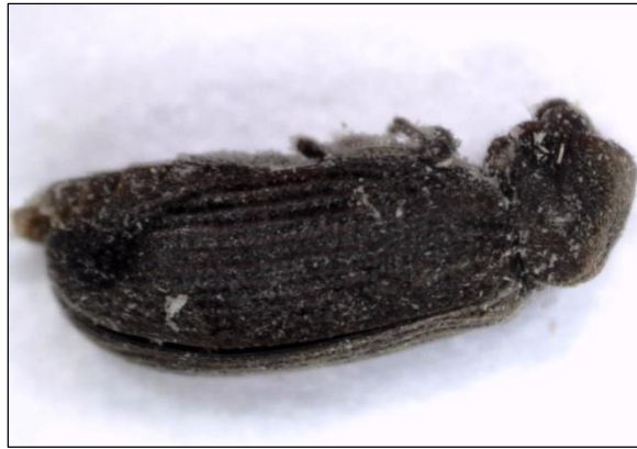
Slika 50. Odrasli mrtvi kukac Anobium Punctatum pod mikroskopom dino-lite, unutar drvenog nosioca u donjem dijelu plašta, fotografirala S. Knežević, ožujak 2023.
