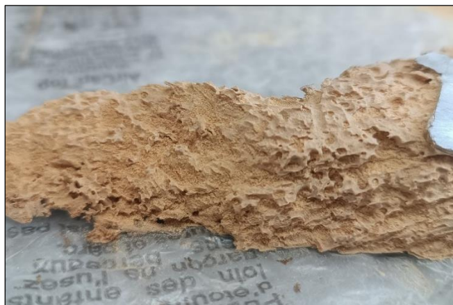
Slika 45. Otpali dio stražnjeg dijela plašta s oštećenjima drvenog nosioca nastalog utjecajem crvotočine, Martin Mittermayr, skulptura sv. Ladislava, kraj 18. st., fotografirala: S. Knežević, veljača, 2024.
