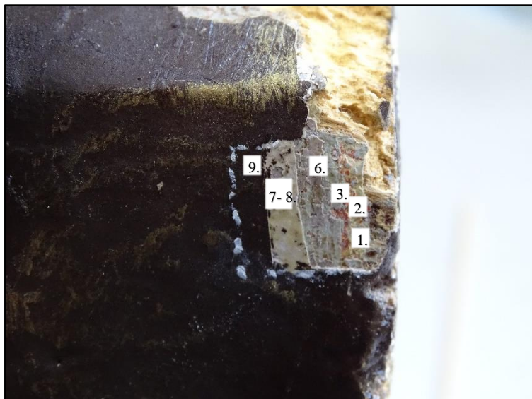
Slika 54. Sonda 2 Stratigrafski slojevi na postolju, fotografirala: S. Knežević, prosinac 2023.), (broj na slici prati tehnološke slojeva u tablici 2)
