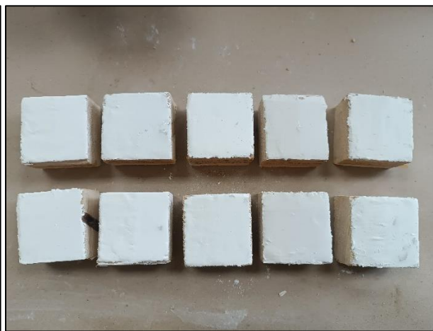
Slika 160. Testne pločice, različitih proba osnova prve 3 testne pločice su 7%-tna kredno-tutkalna osnova s različitim ukupnim udjelom kredne u sebi, četvrta pločica je kredno planatolska osnova, zadnja je stuki , fotografirala: S. Knežević, lipanj 2024.
