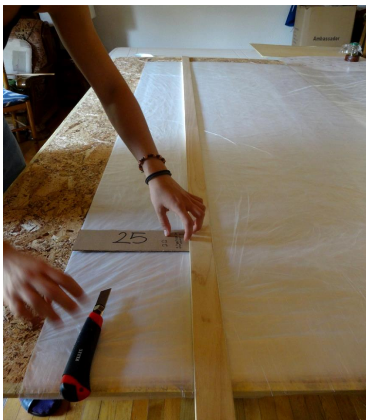
Fotografija 11: Mjerenje potrebne širine najlona prije rezanja
