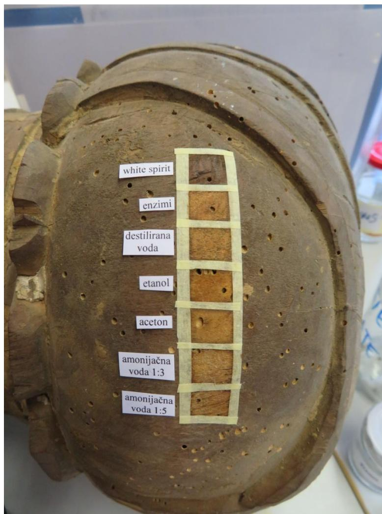
Slika 36. Probe čišćenja na drvenom nosiocu, detalj
