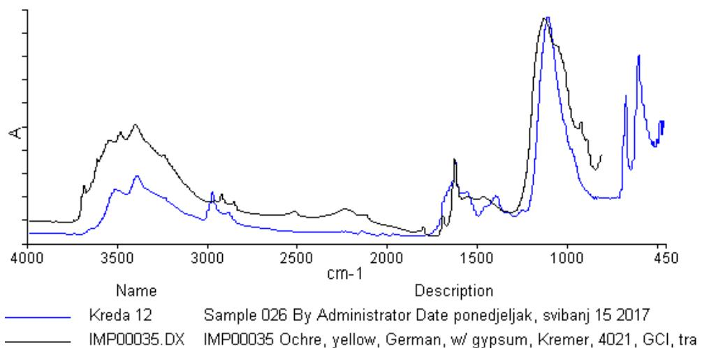
Slika 39. FTIR analiza, određivanje sastava krede
