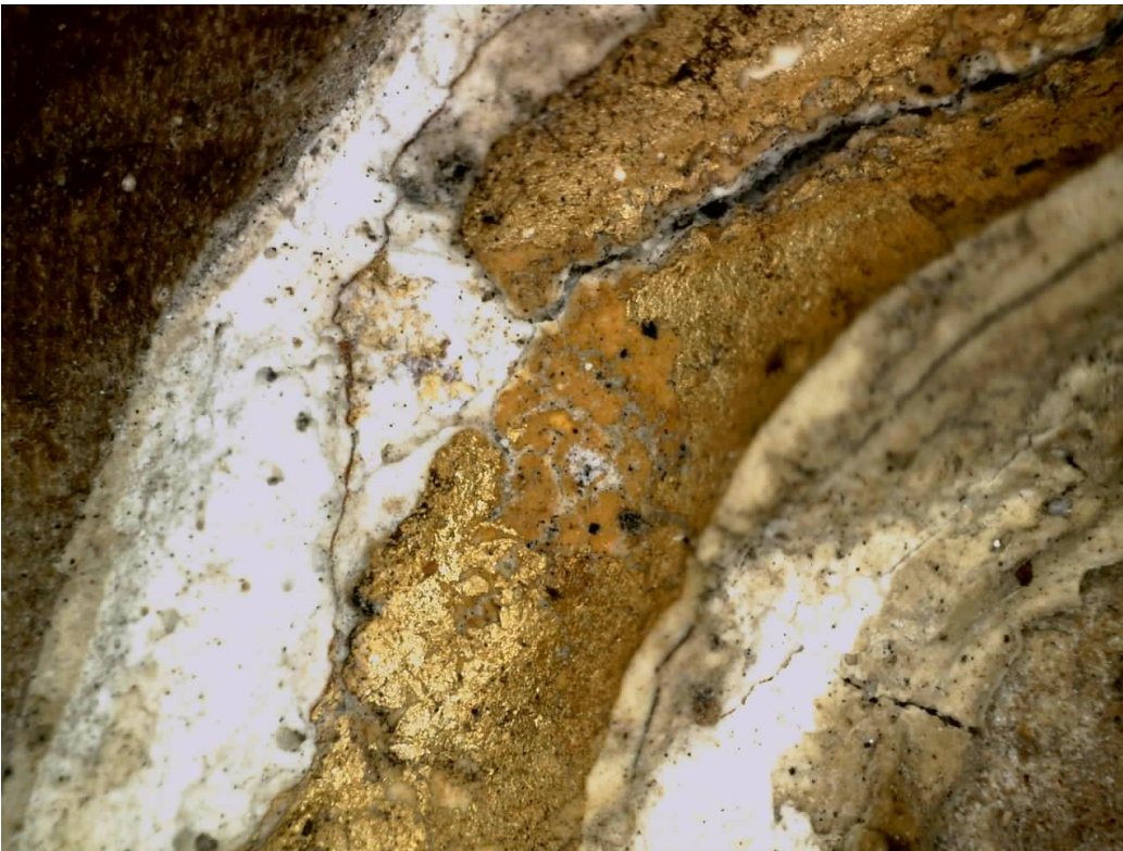
Slika 82. Pozlata na kruni, detalj, snimak Dino-lite mikroskopom
