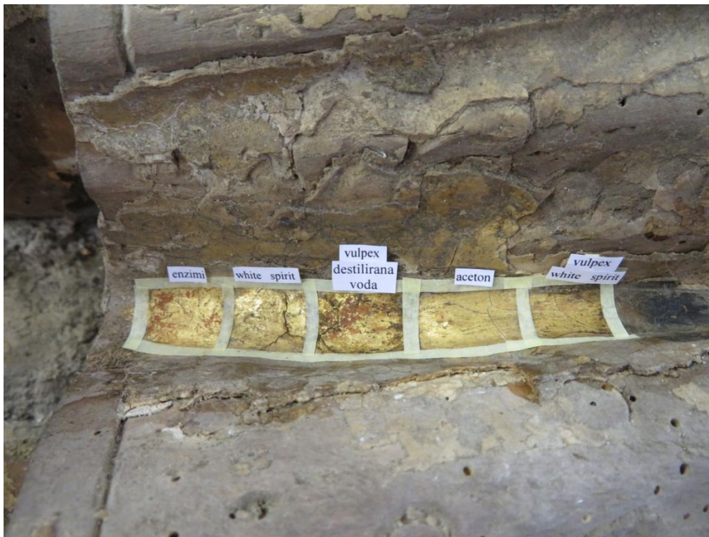
Slika 37. Probe čišćenja na pozlati, detalj
