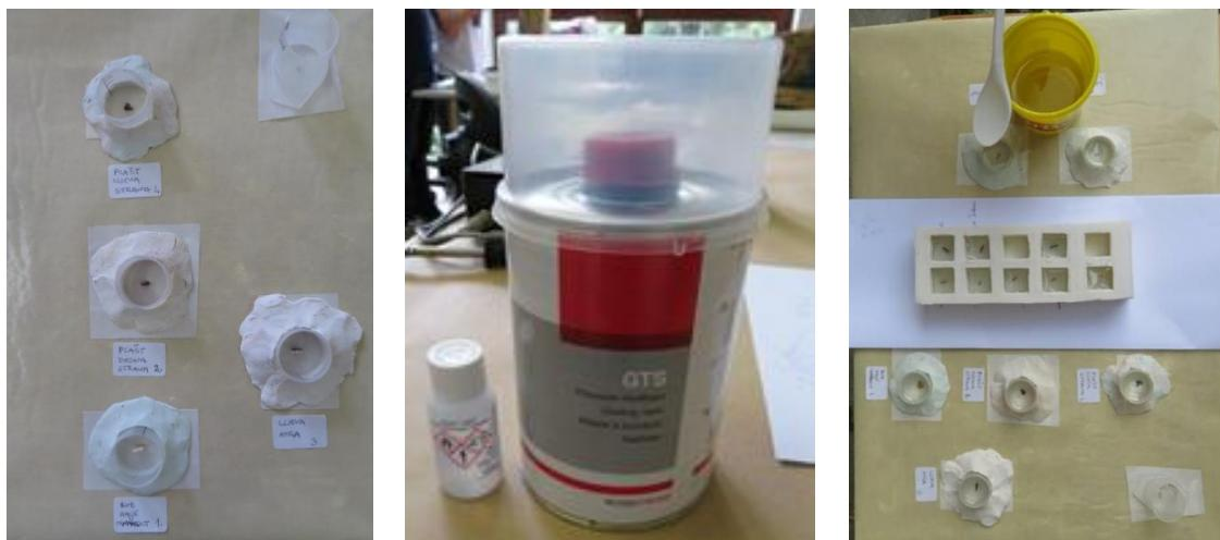
Slika 33. Izrada poprečnog presjeka mikrouzoraka
