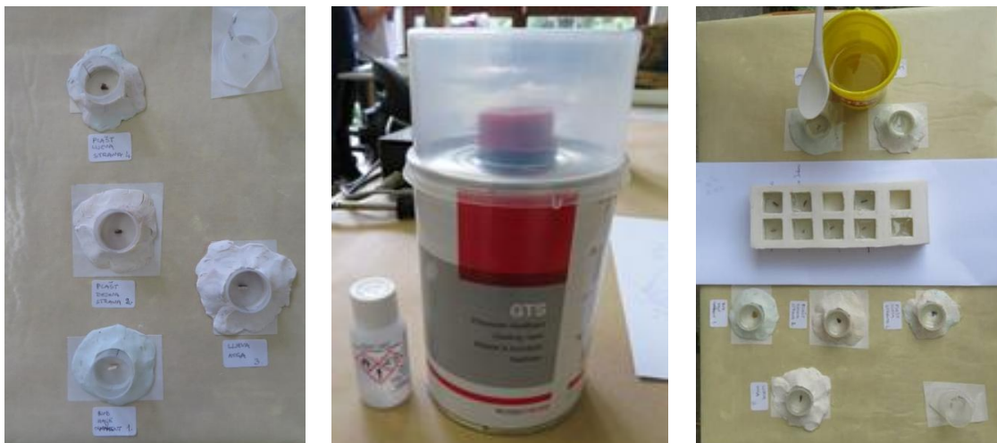
Slika 33. Izrada poprečnog presjeka mikrouzoraka
