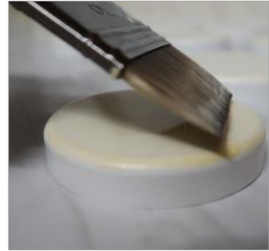
Sl. 45. Nanošenje slikanog sloja na podlogu
