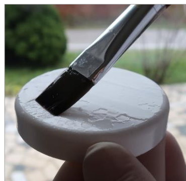
Sl. 27. Nanošenje otopine arapske gume na zagrijane polietilenske podloge
