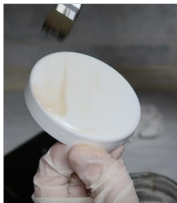
Sl. 33. Nanošenje pripremljenog kazeina na zagrijane polietilenske podloge
