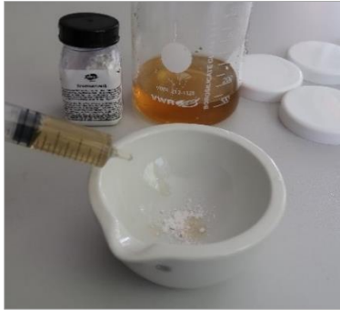
Sl. 37. Dodavanje arapske gume praškastom pigmentu olovne bijele
