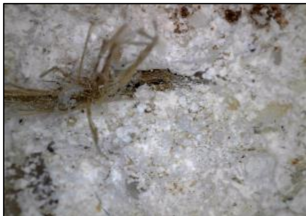
Slika 69. Pregled površine žbuke s poledine digitalnim mikroskopom (Dino-Lite) – uvećana fotografija zrnca punila i dodataka (komadi drva)
