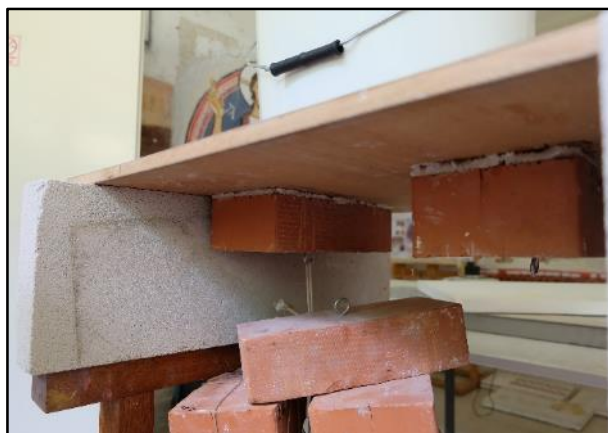
Slika 98. Izlaganje sloja PUR pjene opterećenju
