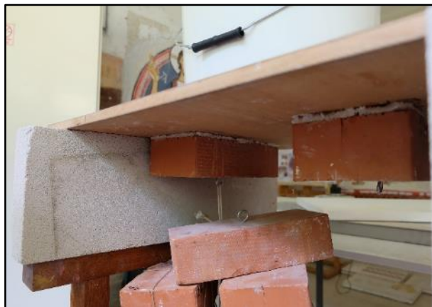
Slika 98. Izlaganje sloja PUR pjene opterećenju
