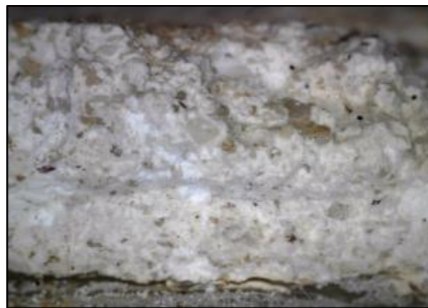
Slika 72. Detalj, uvećana fotografija stratigrafije žbukanih slojeva (presjek)
