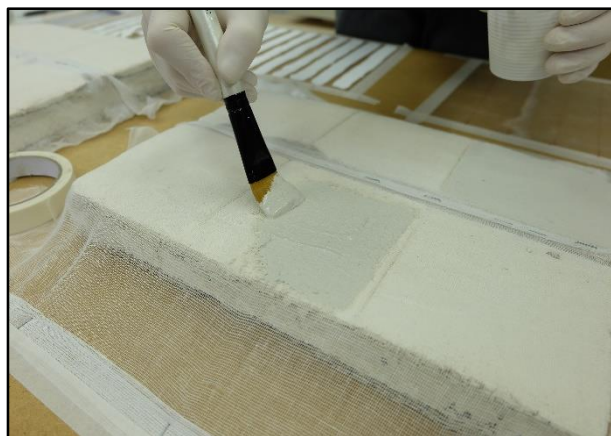
Slika 95. Nanošenje smjese PLM-AL na probne ploče
