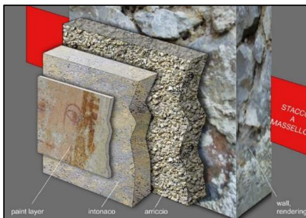
Slika 1. Odvajanje sloja boje zajedno s nosiocem i žbukama, preuzeto iz prezentacije „Transfer zidnih slika“, Rado Zoubek
