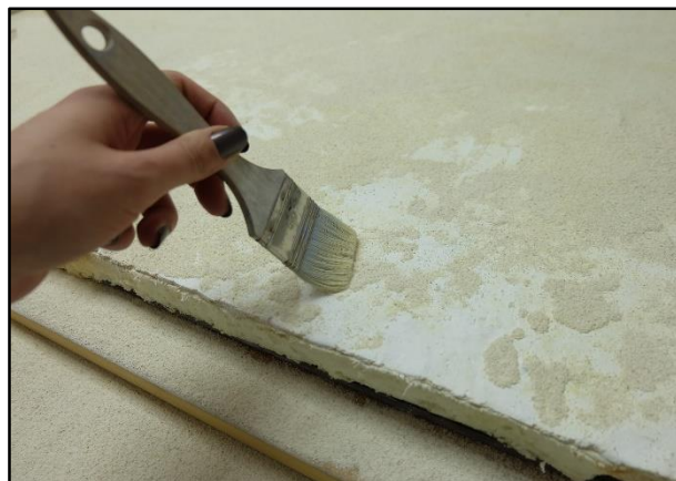
Slika 110. Otprašivanje viška pijeska pomoću kista
