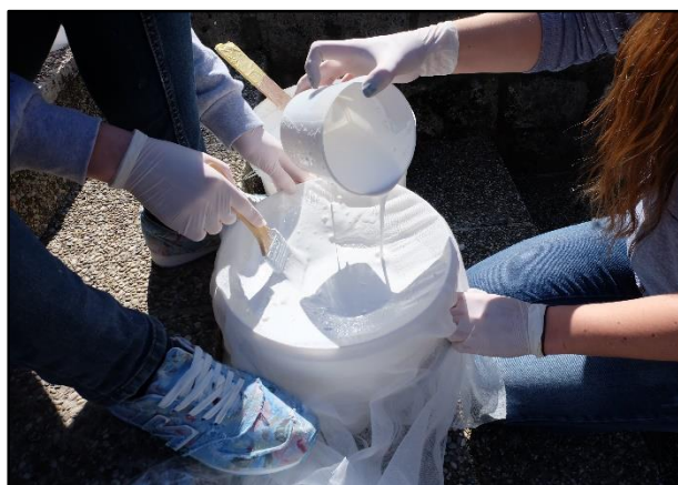
Slika 104. Priprema vapnenog kazeinata 4 : 1 : 1 – vapno : kazein : SOKRAT
