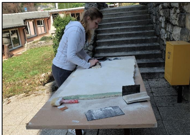
Slika 109. Uklanjanje viška pijeska brusnim papirom kako bi se dobila ravna površina
