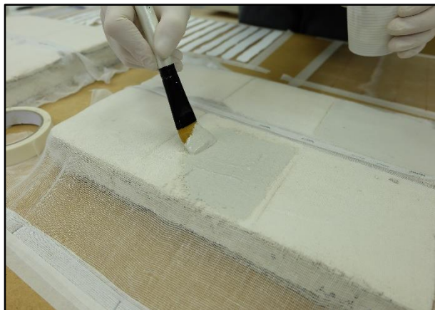
Slika 95. Nanošenje smjese PLM-AL na probne ploče
