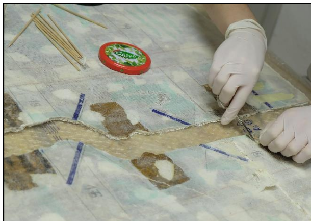
Slika 118. Proba skidanja facinga na rubnim dijelovima fragmenta
