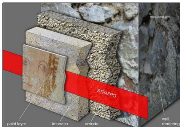
Slika 6. Odvajanja samo slikanog sloja, preuzeto iz prezentacije „Transfer zidnih slika“, Rado Zoubek
