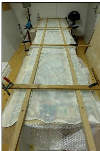
Slika 122. Postavljanje stege na letvice kako ne bi došlo do ekspaniranja PUR pjene
