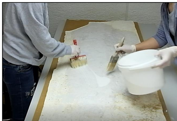
Slika 139. Nanošenje prvog sloja vapnenog kazeinata.
