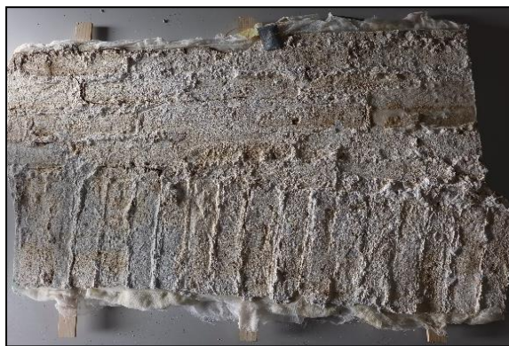
Slika 131. Ostaci žbuke sljubnica na poleđini srednjeg dijela fragmenta (dio fragmenta 2); svojevrsan otisak opečnog nosača (zida) u negativu.
