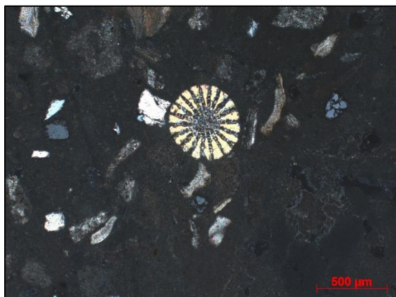
Slika 11. Mikrofotografija ispoliranog tankog presjeka uzorka 2. Transmisijsko svjetlo, ukršteni polari.
