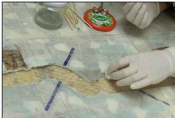
Slika 150. Djelomično uklanjanje facinga pamučnim tamponima natopljenim acetonom.
