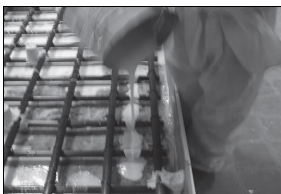
Slika 49. Lijevanje epoksidne pjene preko mreže od karbonskih cijevi.
