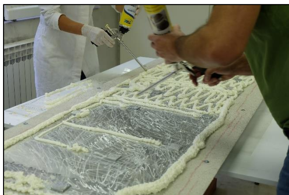
Slika 166. Nanošenje poliuretanske pjene na aluminijsku ploču pokretnog nosača.
