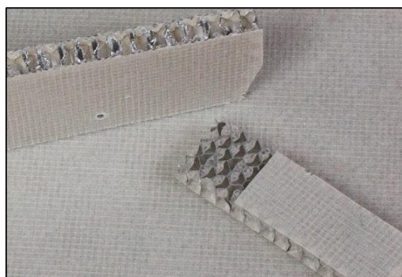
Slika 15. Alustep 500 light sendvič ploča s aluminijskom jezgrom i vanjskom oplatom od impregnirane stakloplastike.
