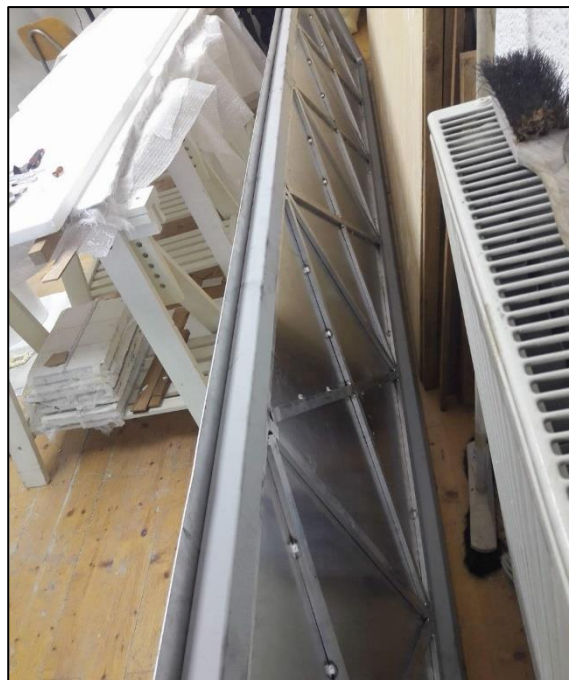
Slika 156. Poledina pokretnog nosača od aluminijskih letvica s pričvršćenom privremenom ukrutom od čeličnih greda.
