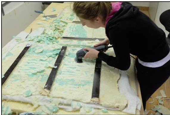
Slika 148. Stanjivanje poliuretanske pjene električnom brusilicom.
