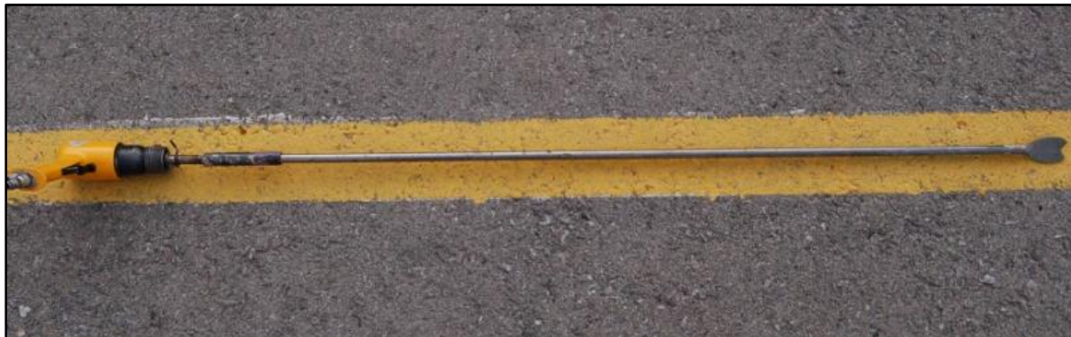
Slika 13. Dugačko metalno "koplje" za odvajanje zidnih slika postavljeno na pneumatski čekić.
