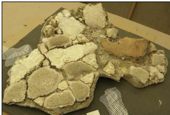
Slika 28. Komadići Dryvit staklene mrežice pričvršćeni su žbukom sastavljenom od inekcione smjese VAP0 0/1 i punila od recikliranog stakla.
