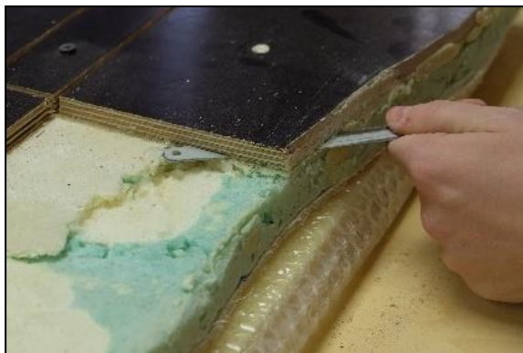
Slika 146. Odvajanje izrezanih, manjih komada panel ploča od poliuretanske pjene tankim metalnim pilama.
