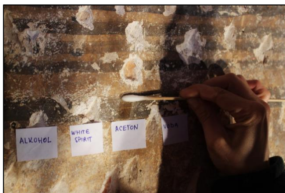
Slika 116. Probe otpornosti slikanog sloja na otapala veziva facinga : alkohol, white spirit , aceton i destilirana voda (s lijeva na desno).
