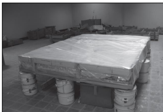
Slika 50. Odvojen fragment zidne slike temeljito umotan u prijanjajuću foliju kako bi se onemogućila sublimacija ciklododekana do nastavka radova.
