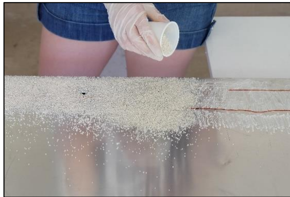
Slika 164. Posipanje vapnenačkog drobljenca na svjež nanos epoksidnog ljepila.
