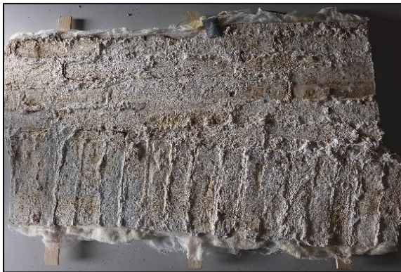
Slika 131. Ostaci žbuke sljubnica na poledini srednjeg dijela fragmenta (dio fragmenta 2); svojevrsan otisak opečnog nosača (zida) u negativu.
