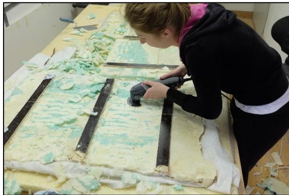
Slika 148. Stanjivanje poliuretanske pjene električnom brusilicom.
