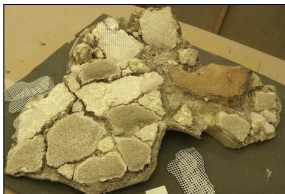
Slika 28. Komadići Dryvit staklene mreže pričvršćeni su žbukom sastavljenom od inekcione smjese VAP0 0/1 i punila od recikliranog stakla.
