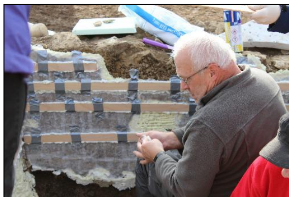
Slika 58. Lijepljenje horizontalnih elastičnih drvenih letvica poliuretanskom pjenu.
