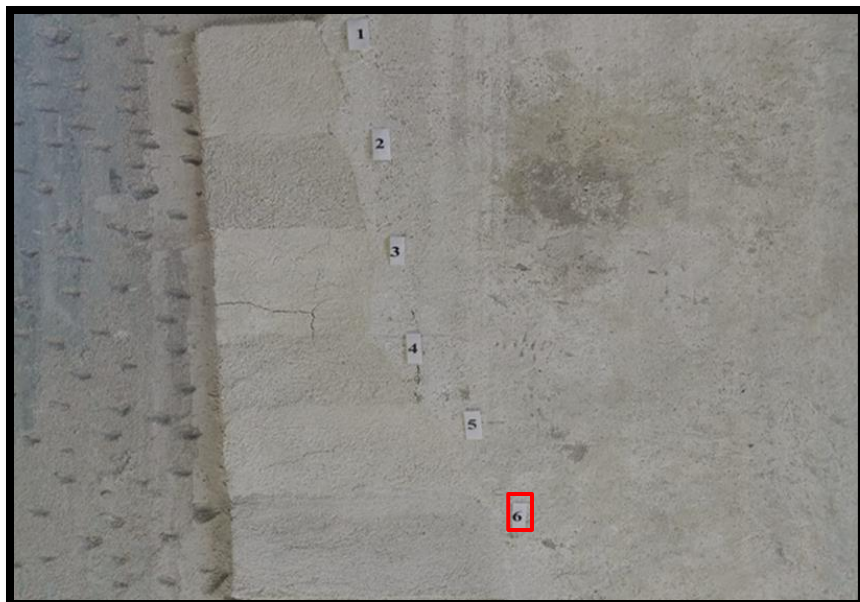
Slika 81 Detalj, proba žbuka na starijem sloju
