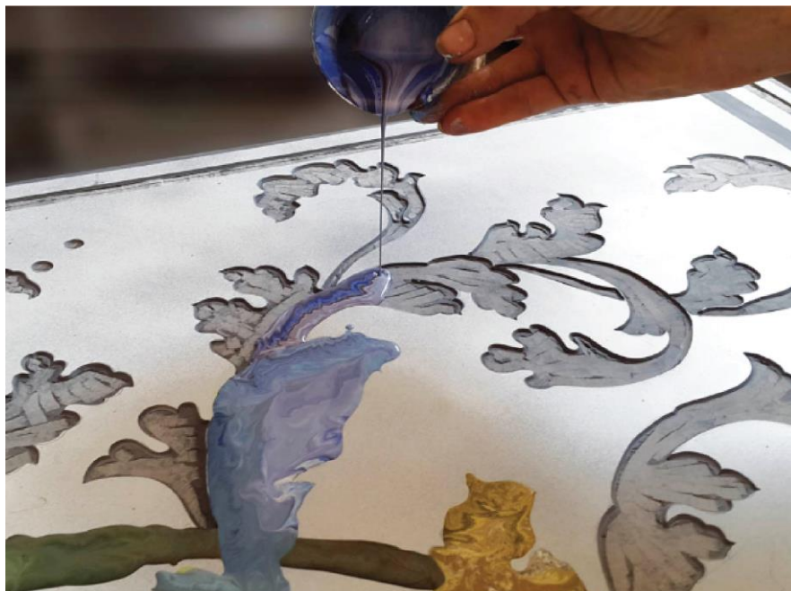
Sl. 142 – Ulijevanje smjese u izdubljenu površinu
