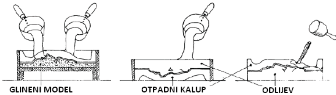
Sl. 125 - Shematski prikaz lijevanja modela uz pomoć otpadnog kalupa
