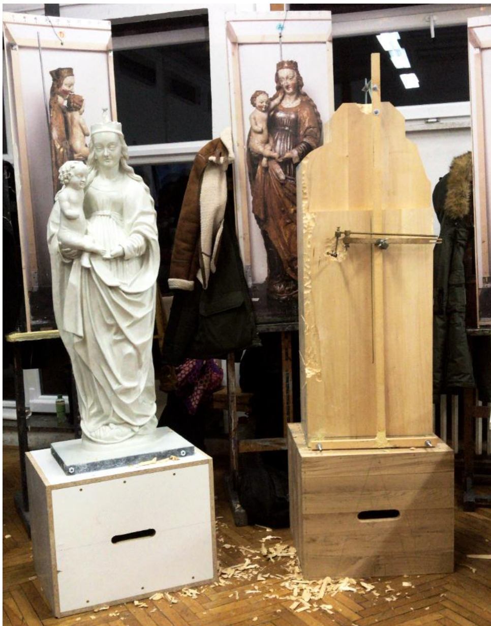
Slika 149: Početak procesa punktiranja na drvu
