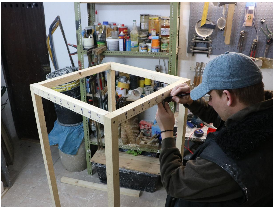
Slika 72: Izrada okvira za punktiranje te ispisivanja mjera na okviru
