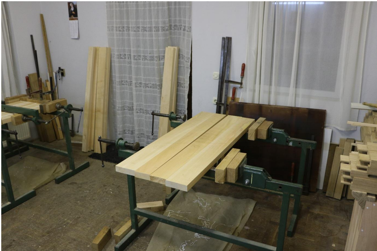
Slika 125: Set stega koji se koristio za širinsko lijepljenje
