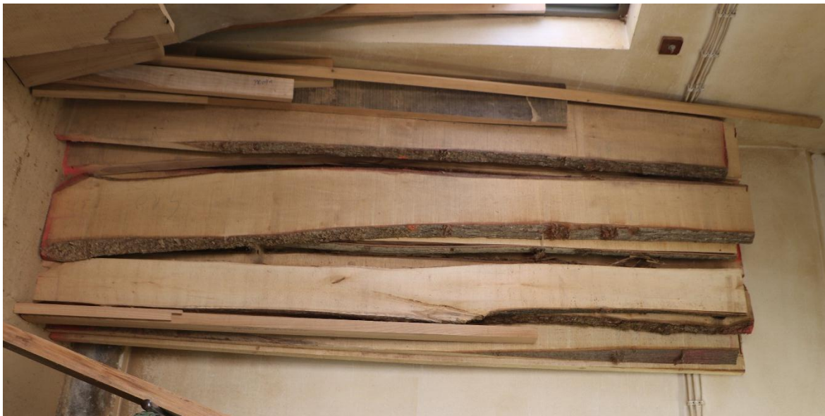
Slika 116: Pripremljeno osušeno lipovo drvo u fosnama 75
