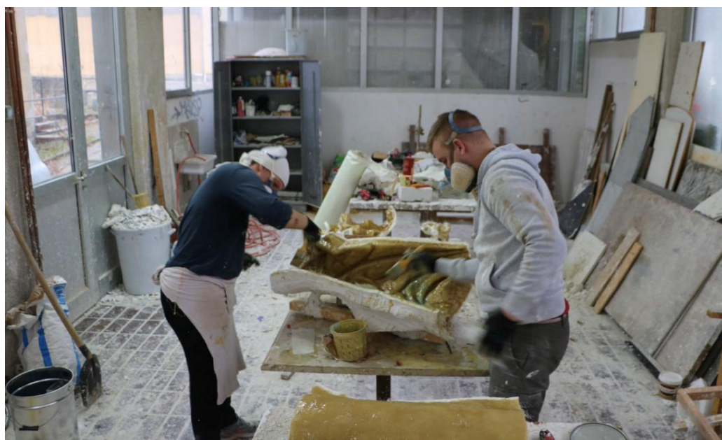
Slika 109: Nanošenje drugog sloja sa staklenim matom
