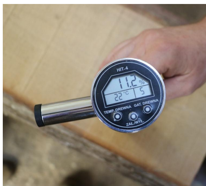
Slika 119: Prikaz pomoću vlagometra izmjerenih 11.2 % vlage u drvu
