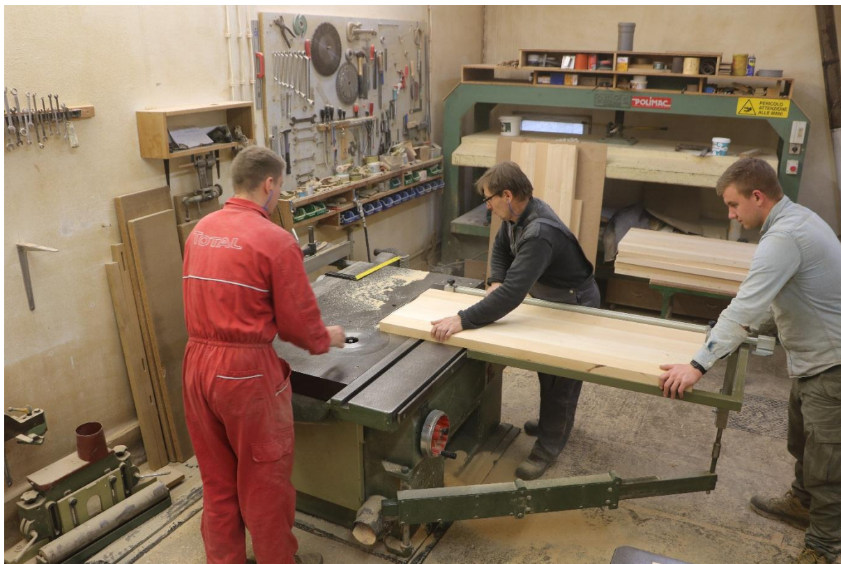
Slika 132: Rezanje ploča na stolnom cirkularu
