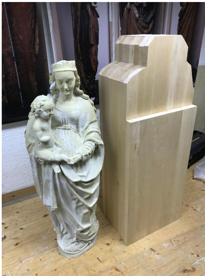
Slika 146: Poliesterski odljev skulpture pokraj pripremljenog lameliranog drveta prije punktiranja
