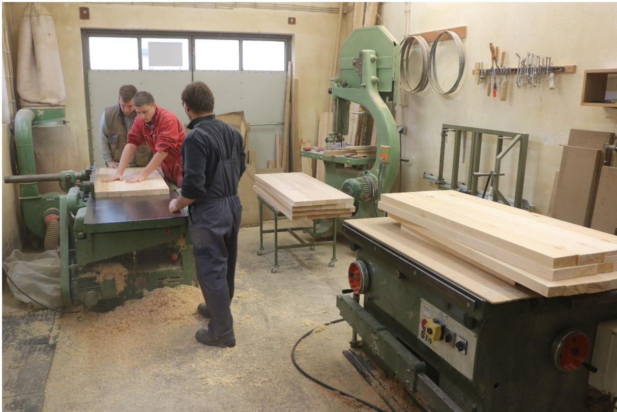
Slika 130: Ravnanje zalijepljenih lameliranih ploča
