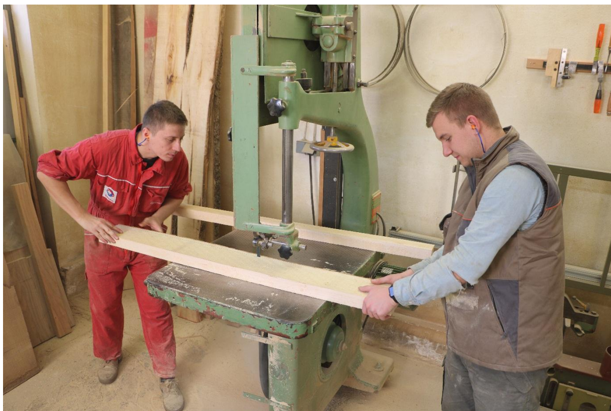
Slika 121: Rezanje fosni na tračnoj pili
