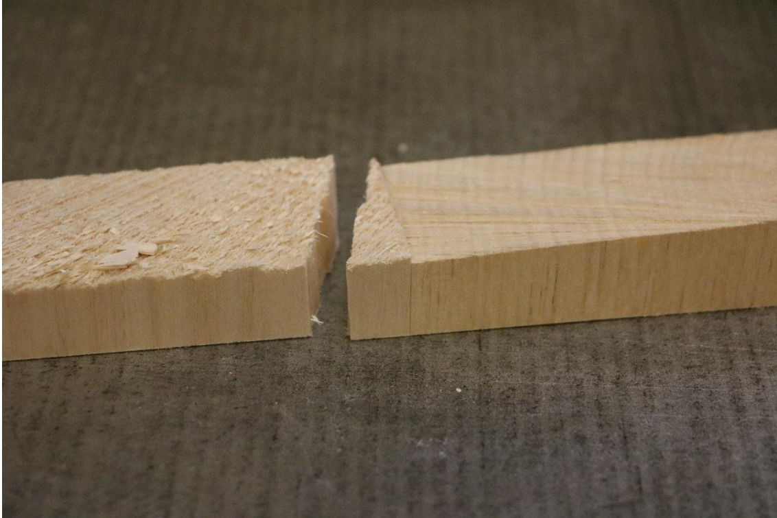
Slika 134: Rezultat testa: ljepilo je čvrsto i drvo prije puca na vlaknima nego na spoju dvije daske
