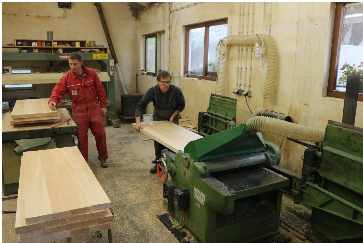
Slika 131: Svodenje svih dasaka na istu debljinu puštanjem kroz debljaču
