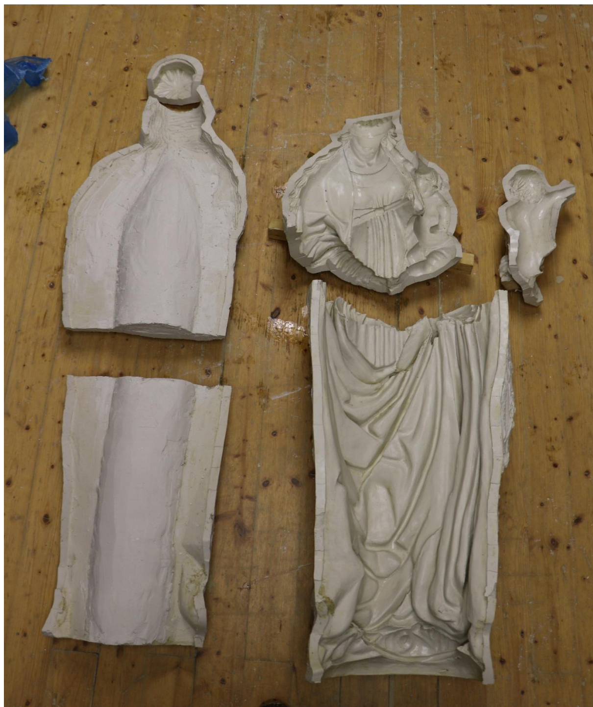
Slika 107: Oprani gipsani kalupi ostavljaju se na sušenje
