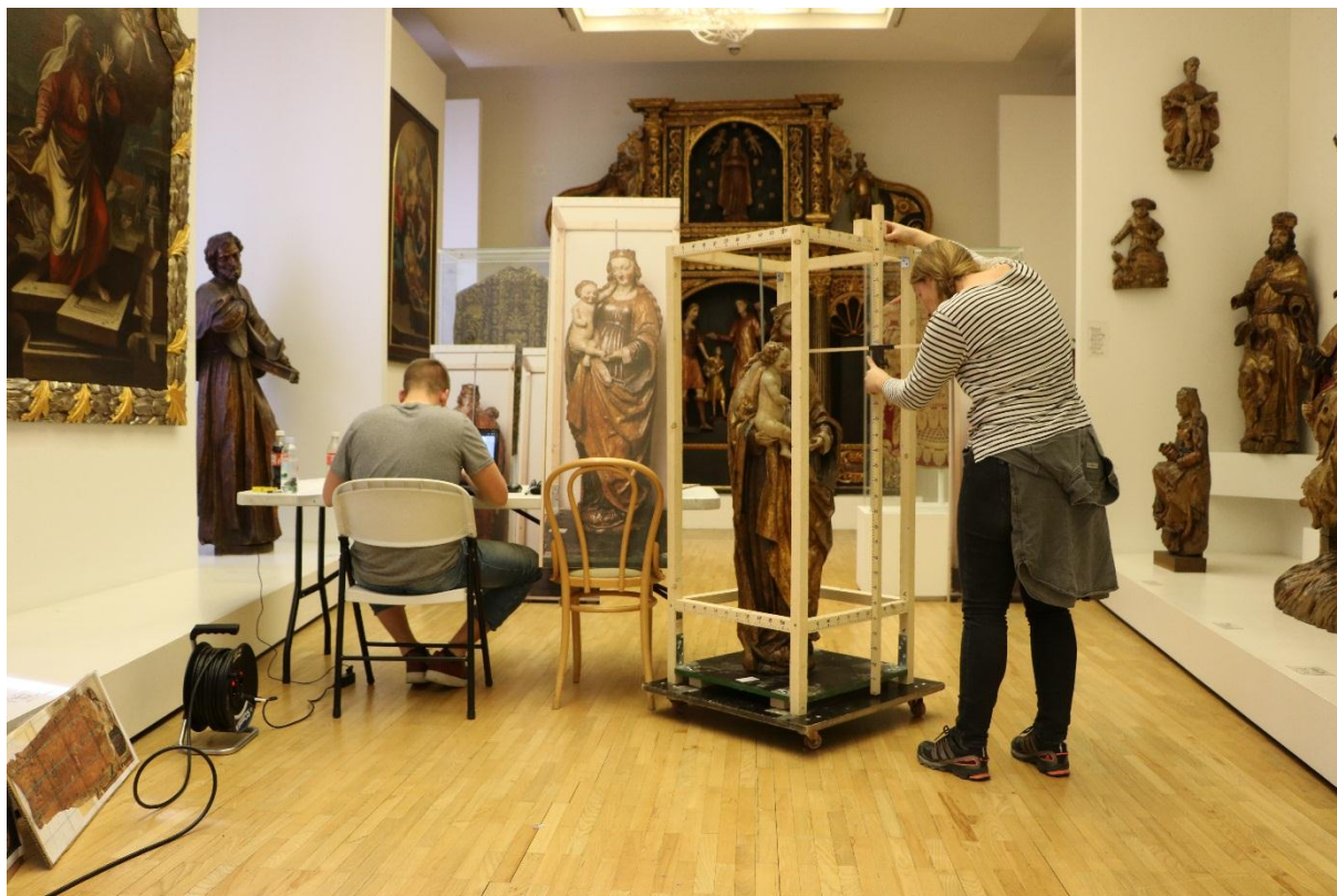
Slika 75: Uzimanje točke s izvorne skulpture i zapisivanje njezine pozicije u tablicu
