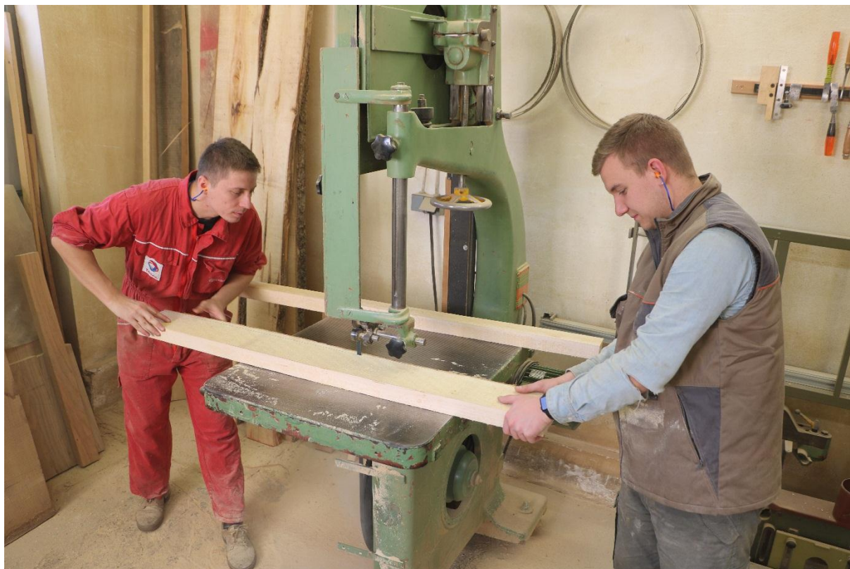
Slika 121: Rezanje fosni na tračnoj pili
