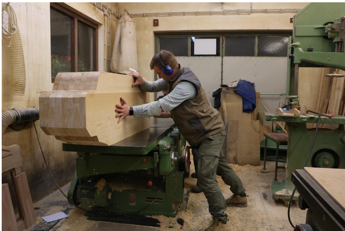
Slika 143: Završno ravnanje bočnih strana i nepravilnosti
