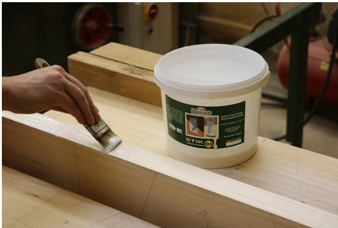
Slika 126: Nanošenje D3 ljepila kistom na bočne stranice
