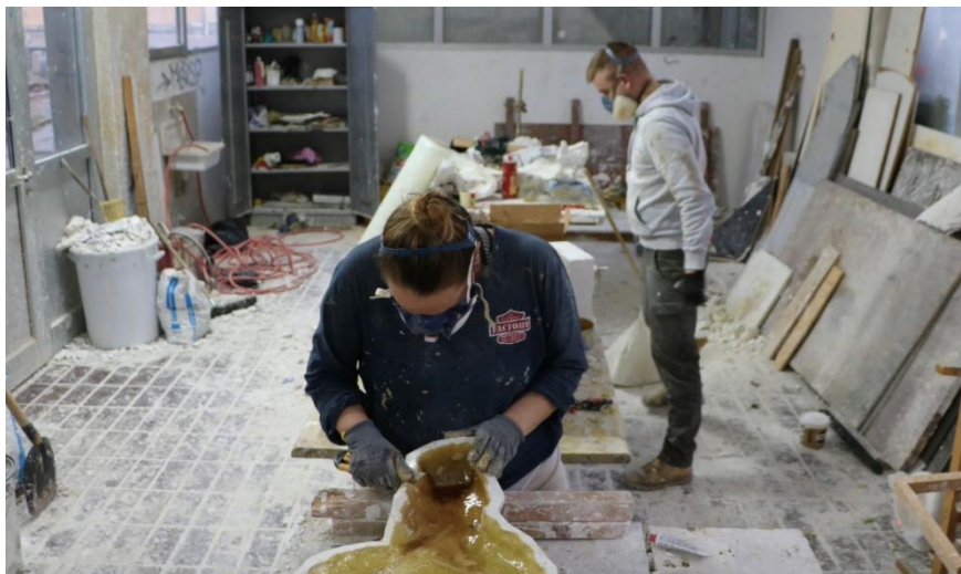
Slika 110: Precizno čišćenje rubova kako bi kalupi što bolje prijanjali jedan uz drugog
