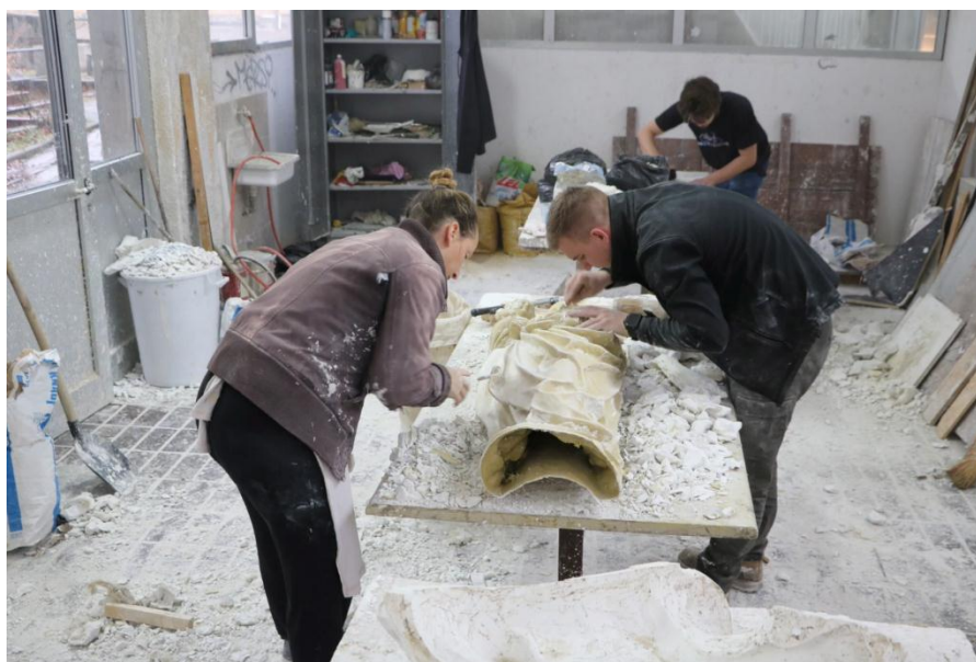
Slika 114: Čišćenje komadića gipsa koji su ostali u konkavnim formama draperije uz pomoć dlijeta
