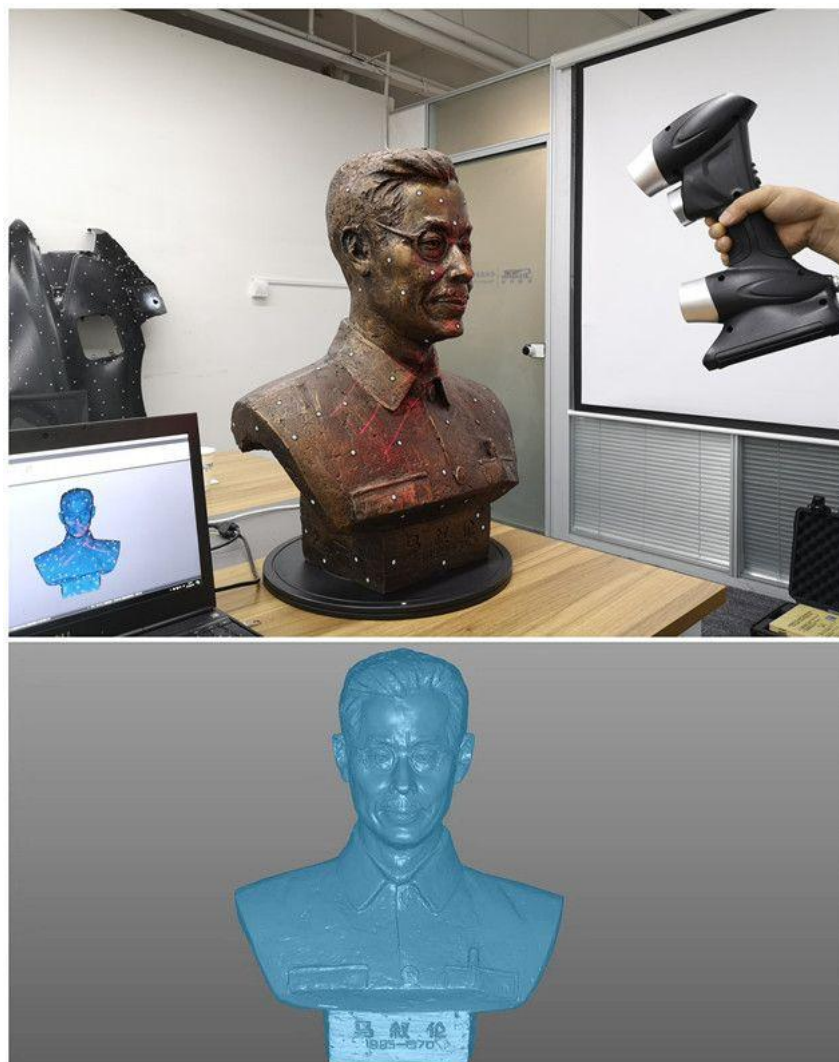
Slika 62: Skeniranje biste pomoću „ PRINCE 3D “ skenera 66
