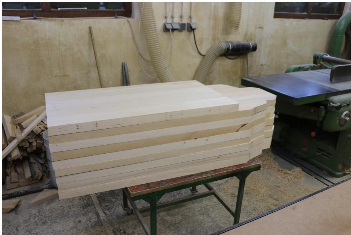
Slika 137: Izrezane i pripremljene ploče za debljinsko ljepljenje
