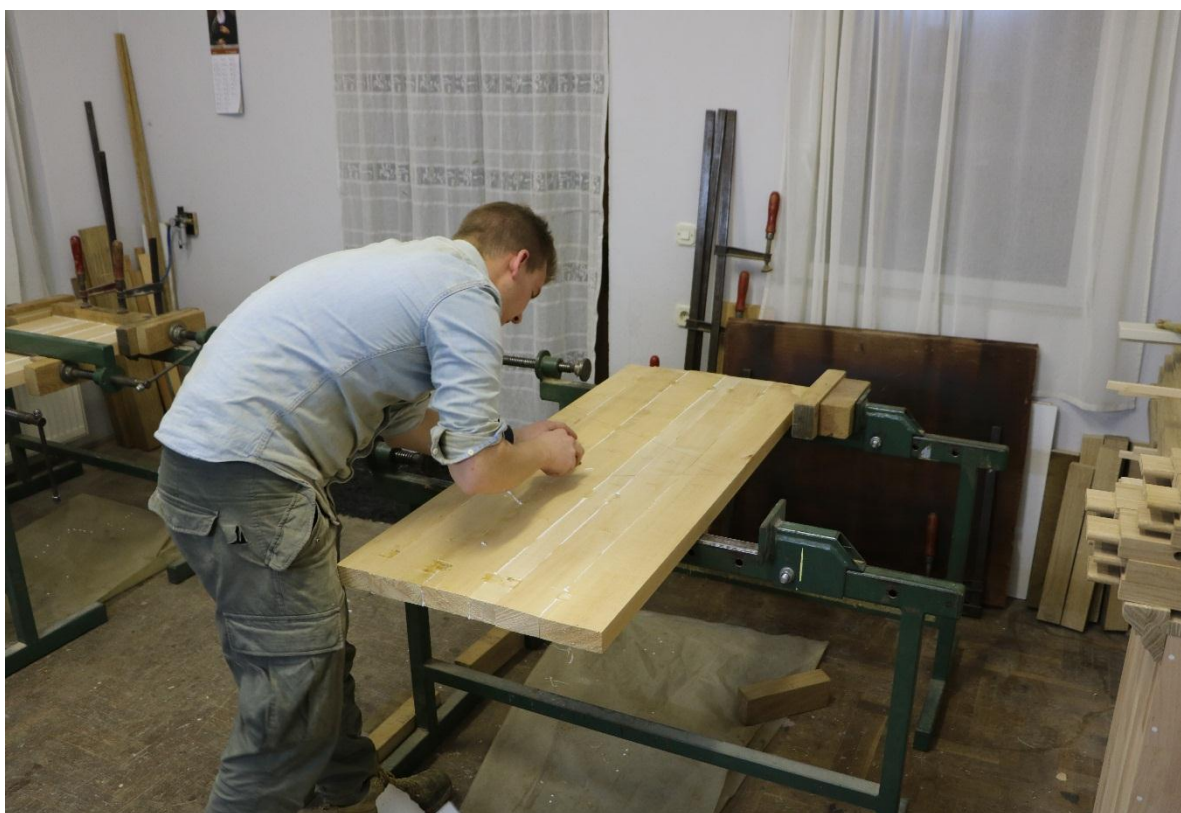
Slika 129: Mehaničko uklanjanje sasušenog viška ljepila
