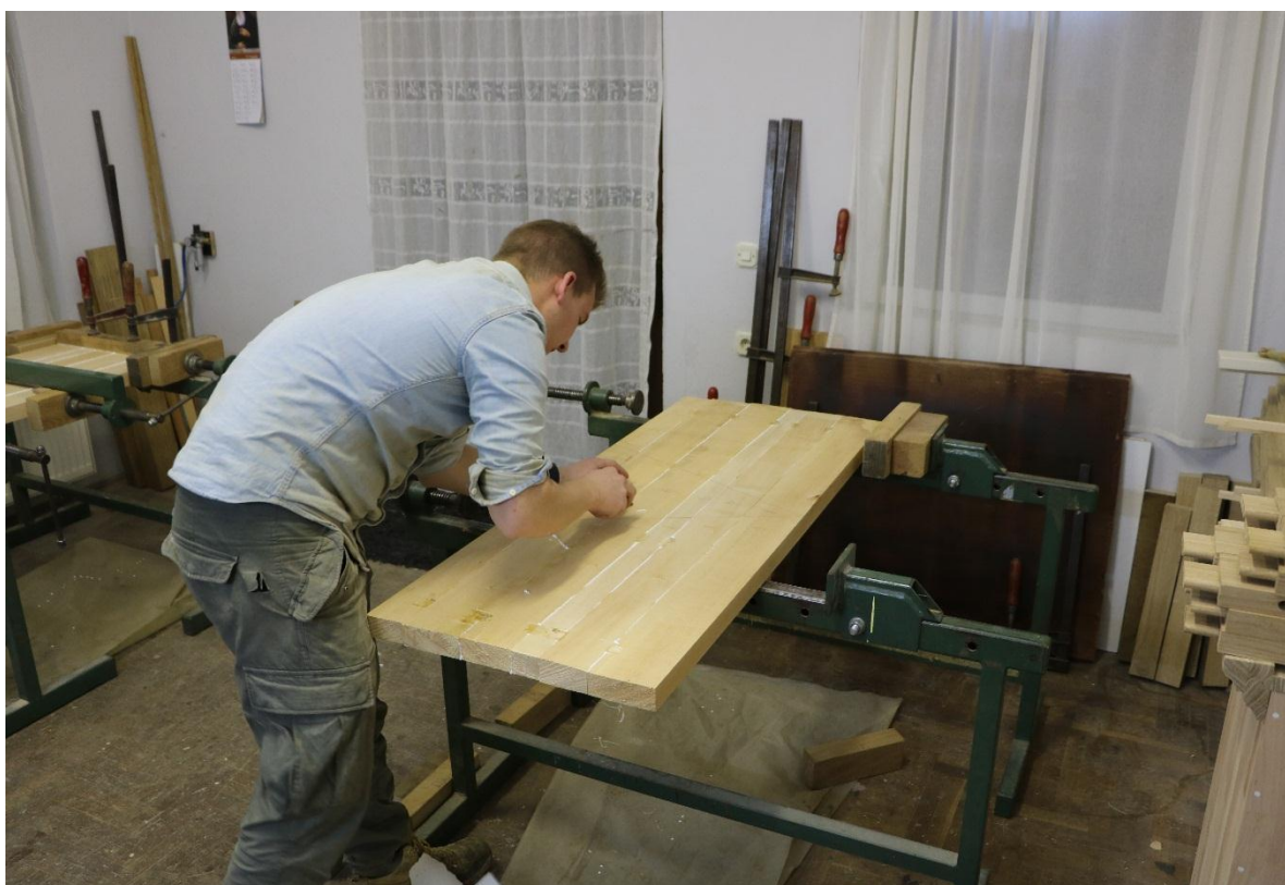
Slika 129: Mehaničko uklanjanje sasušenog viška ljepila
