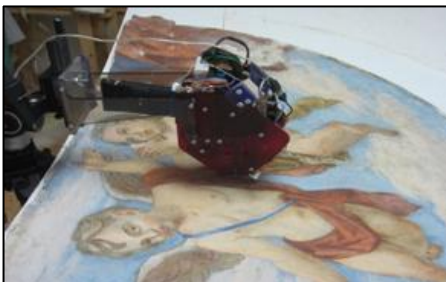
Slika 36. Analiza pigmenata XRF uređajem
