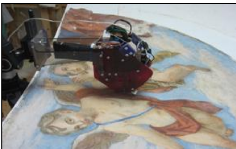
Slika 36. Analiza pigmenata XRF uređajem
