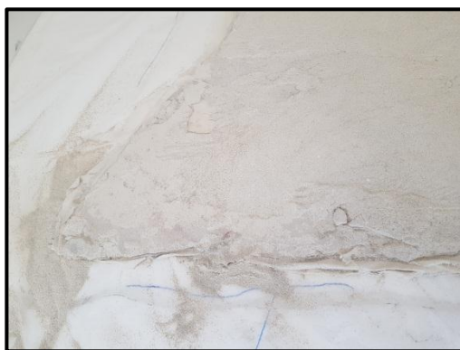
Slika 45. Ostaci izvorne žbuke koji je izložen djelovanju 10% kloridne kiseline
