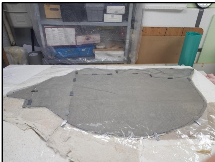
Slika 55. Karbonska mrežica koja je odrezana prema obliku fragmenta u manje dijelove
