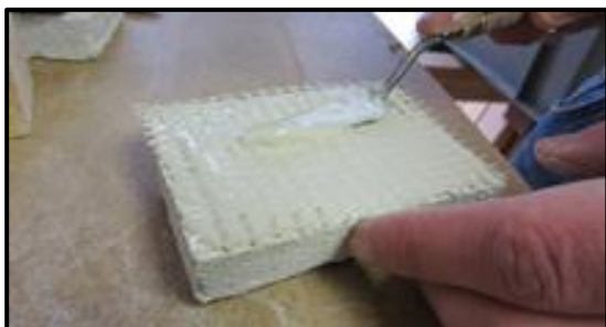
Slika 34. Priprema probnih pločica, uranjanje mrežice u PLM
