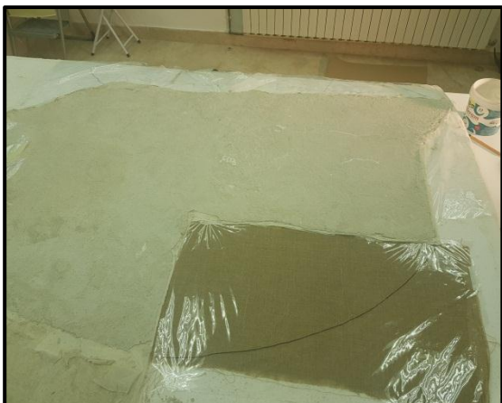
Slika 50. Melinex folija s ocrtanim rubom rekonstruiranog dijela slike
