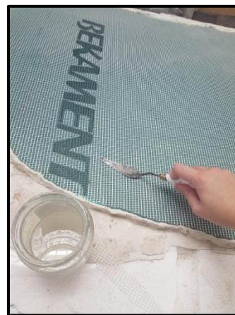
Slika 60. Detalj prilikom nanošenja epoksidne smole
