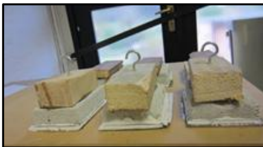
Slika 35. Prikaz probnih pločica sa simulacijom svih slojeva transfera pripremljen za test mehaničke izdržljivosti
