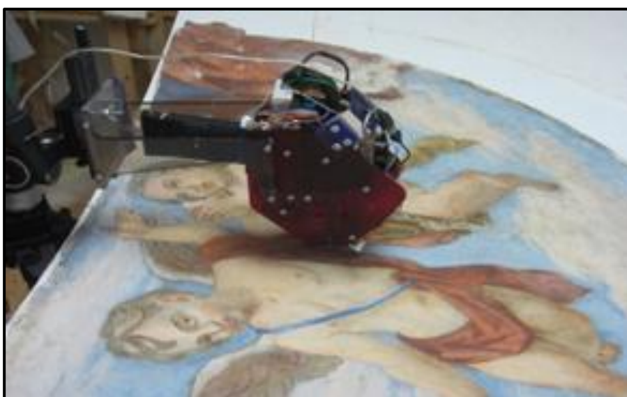
Slika 36. Analiza pigmenata XRF uređajem
