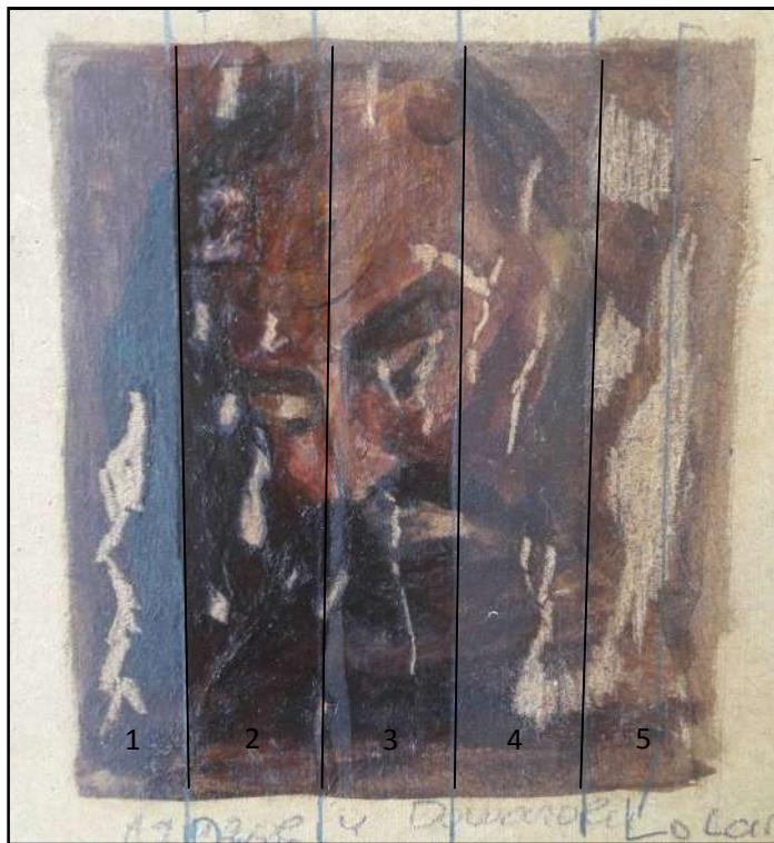
**Slika br. 60,** prikaz prve probe koja je podijeljena na pet vertikalnih traka i na koju su nanešeni lakovi prema redoslijedu u tablici iznad
