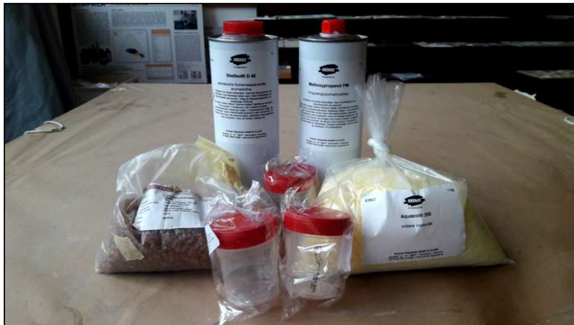
Slika br. 52, korišteni materijali pri izradi konsolidanta, fotografirala Kristina Butković, 2017., OKIRU
