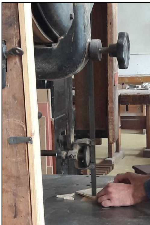
Slika br. 90 , na fotografiji je prikazan korak pri izradi kopije izvorne slike; piljenje drva do željenih dimezija, Škola za primijenjenu umjetnost i dizajn, fotografirala Kristina Butković, 2017., OKIRU
