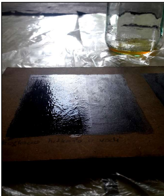
Slika br. 51 , aplikacija 10%-tnog šelaka u listićima otopljenog u špiritnom gorivu, fotografirala Kristina Butković, 2017., OKIRU
