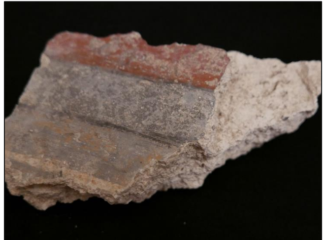
Slika 105. Ulomak s dvoslojnom romaničkom žbukom, lice ulomka
