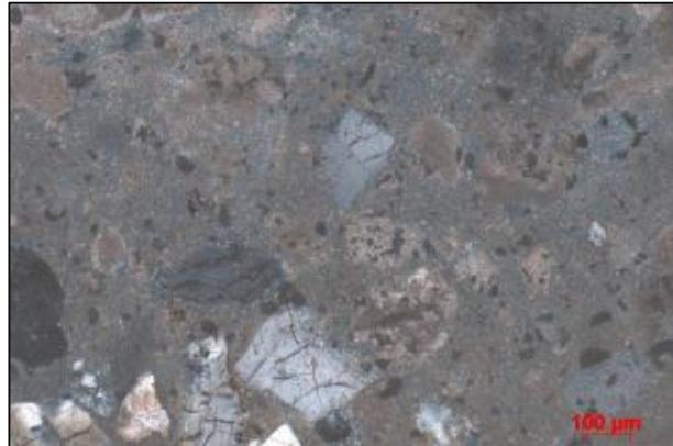
**Slika 126.** Mikroskopski snimak tankog presjeka ukršteni polari
