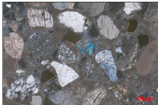
Slika 62. Mikroskopski snimak tankog presjeka, ukršteni polari
