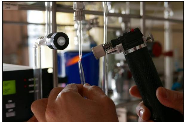
**Slika 44.** Taljenje cjevčice za <sup>13</sup>C
