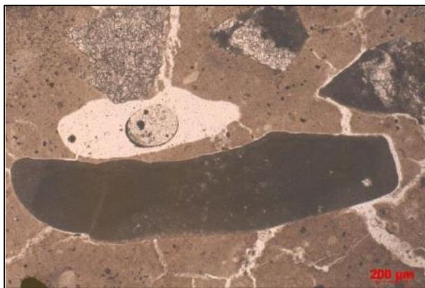
Slika 111. Mikroskopski snimak tankog presjeka 2. sloja, bez polara
