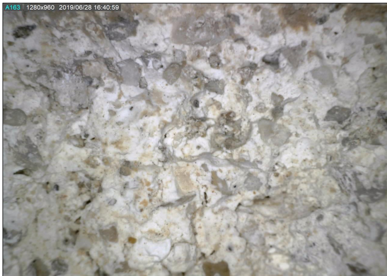
Slika 108. Dino-lite fotografija dvoslojne „romaničke“ žbuke
