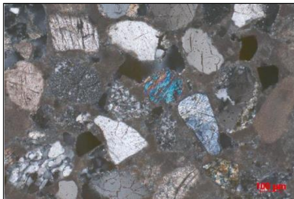
Slika 62. Mikroskopski snimak tankog presjeka, ukršteni polari
