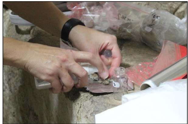
Slika 40. Test lužnatosti fenoftaleinom nakon uzimanja uzorka
