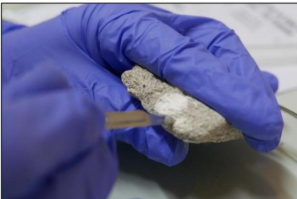
Slika 41. Uzimanje uzorka vavnene čestice iz uzorka sive žbuke
