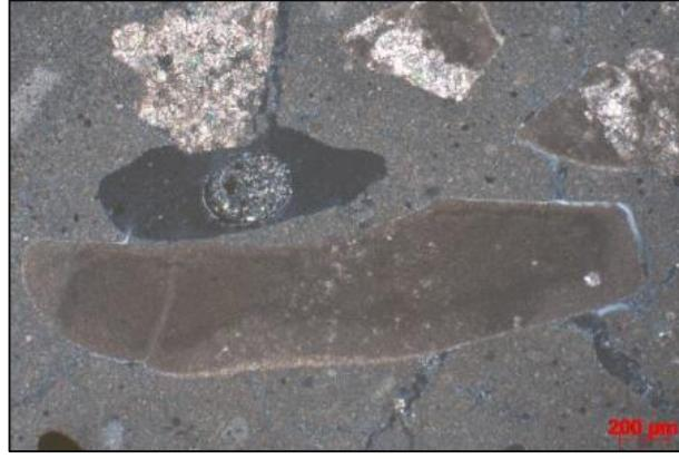
Slika 112. Mikroskopski snimak tankog presjeka 2. sloja, ukršteni polari
