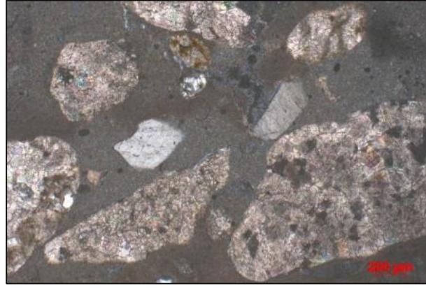
Slika 110. Mikroskopski snimak tankog presjeka 1. sloja, ukršteni polari
