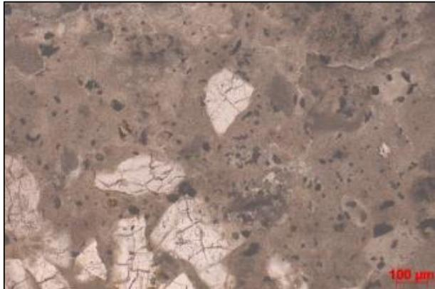
**Slika 125.** Mikroskopski snimak tankog presjeka, bez polara
