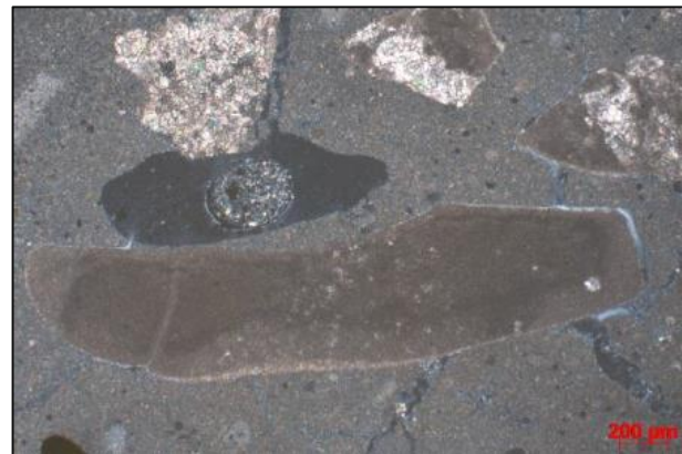
Slika 112. Mikroskopski snimak tankog presjeka 2. sloja, ukršteni polari
