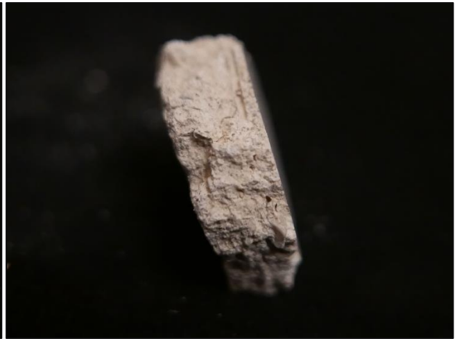
Slika 82. Ulomak bijele sitnozrnate žbuke, bočni presjek
