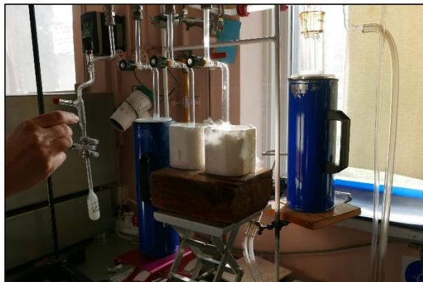
Slika 42. Aparatura s epruvetama uronjenim u tekući dušik
