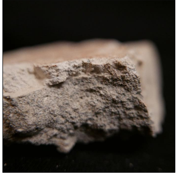
Slika 51. Ulomak s tamnosivom žbukom ispod bijele sitnozrnate, bočni presjek
