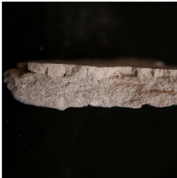
Slika 84. Ulomak bijele sitnozrnate žbuke na tamnosivoj, bočni presjek
