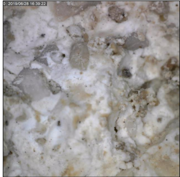
Slika 107. Dino-lite fotografija dvoslojne „romaničke“ žbuke
