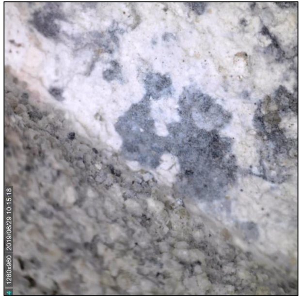
Slika 55. Dino-lite fotografija tamnosive žbuke s naličima, žbuka i slikani sloj
