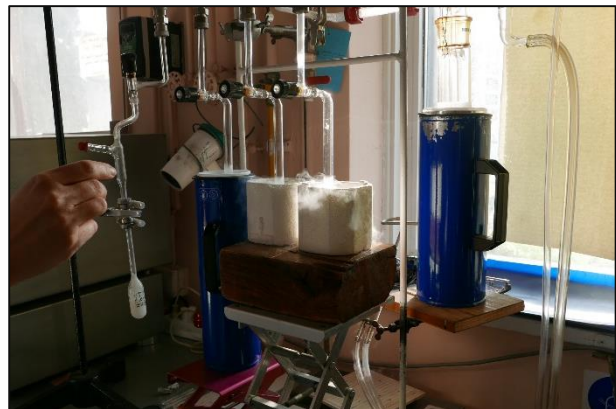
Slika 42. Aparatura s epruvetama uronjenim u tekući dušik
