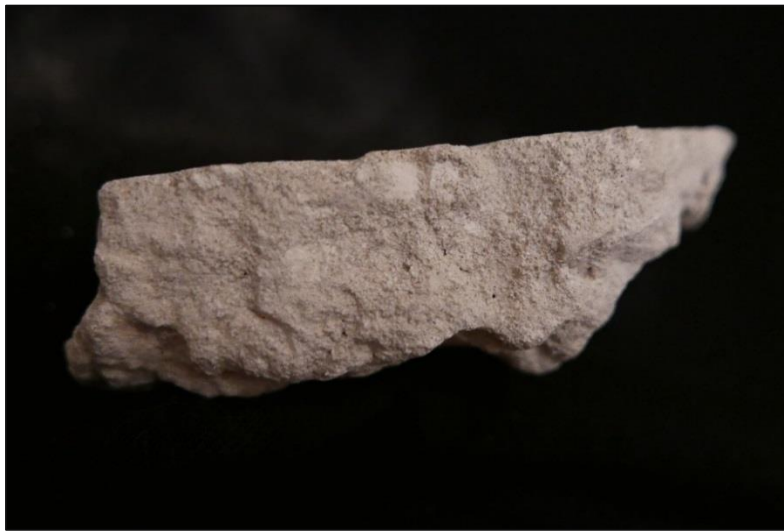
Slika 134. Ulomak sive sitnozrnate, lagane žbuke, bočni presjek
