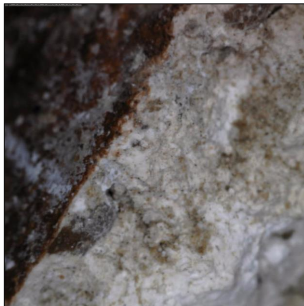
Slika 72. Dino-lite fotografije crvene žbuke s vidljivim oslikom
