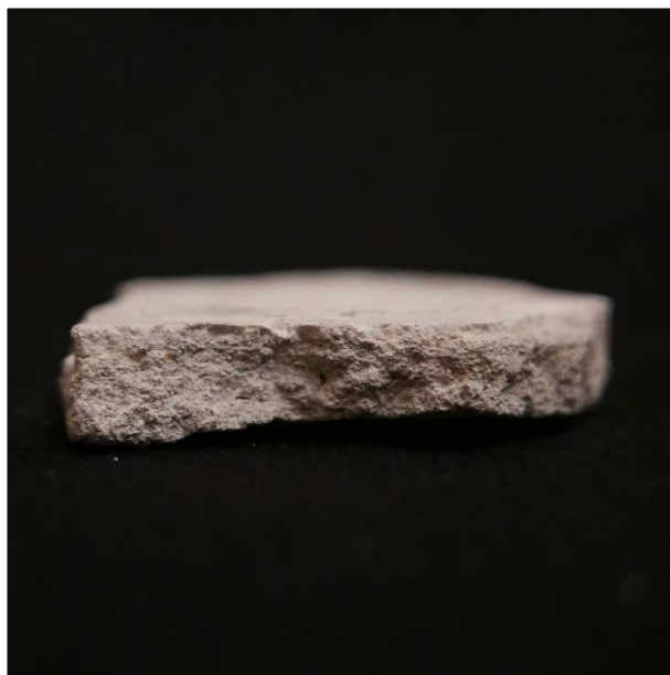
Slika 86. Ulomak bijele sitnozrnate žbuke, bočni presjek
