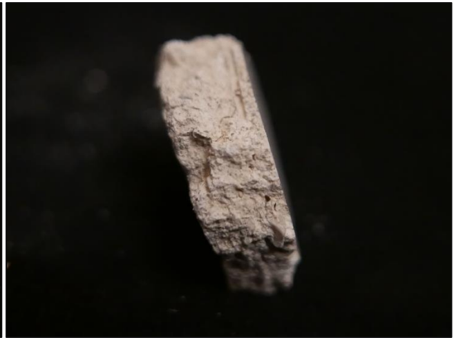
Slika 82. Ulomak bijele sitnozrnate žbuke, bočni presjek
