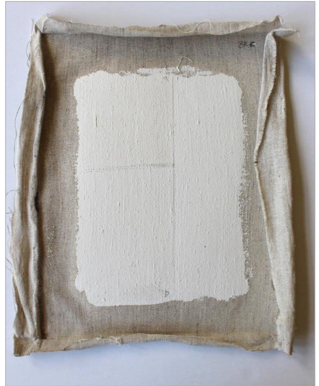
Slika br. 61 , poleđina simulacije slike „Dječak“ na koju je nanesen Lascaux 498 HV
