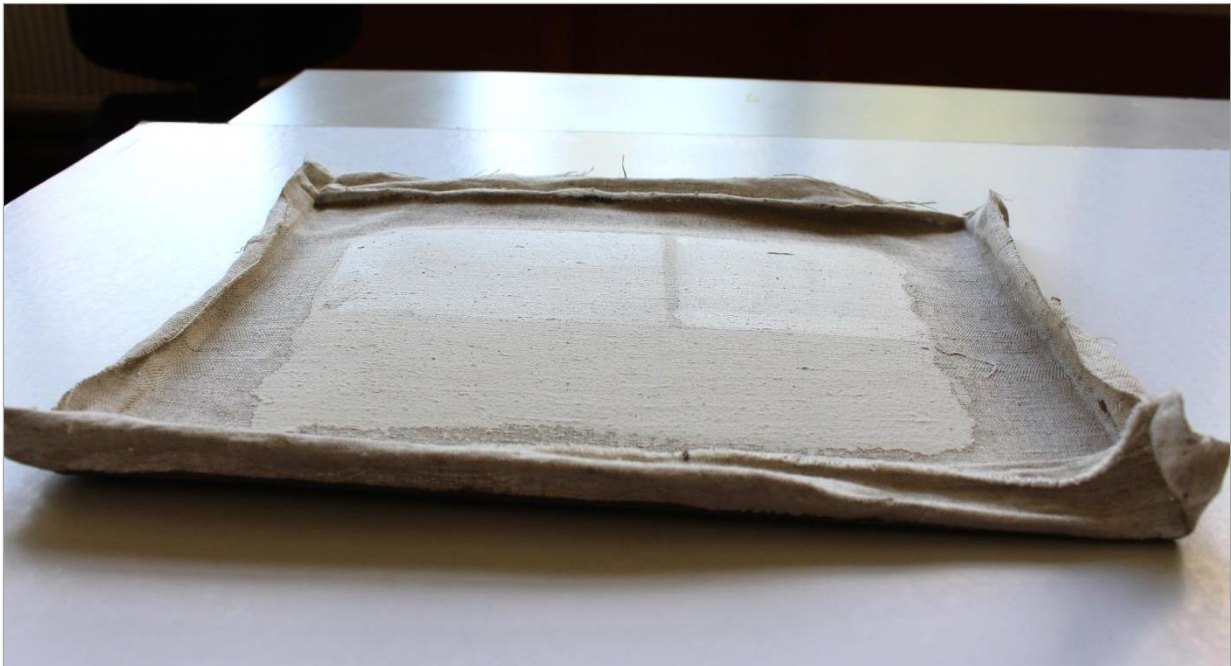
Slika br. 62 , odsjaj poleđine simulacije slike „Dječak“ na koju je nanesen Lascaux 498 HV
