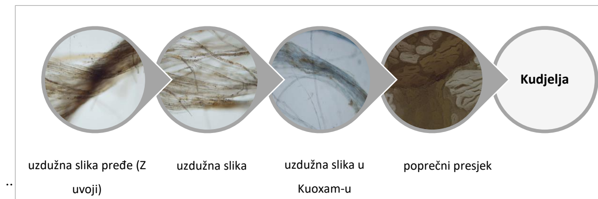
Slika 15 , prikazuje mikroskopske snimke vlakna kudjelje snimljene na Tekstilno-tehnološkom fakultetu u Zagrebu, snimila red. prof. dr. sc. Edita Vujasinović, 2021.
