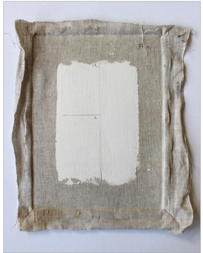
Slika br. 55 , poledina simulacije slike „Dječak“ na koju je nanescna 5 i 10%-tna Beva 371 u white spiritu
