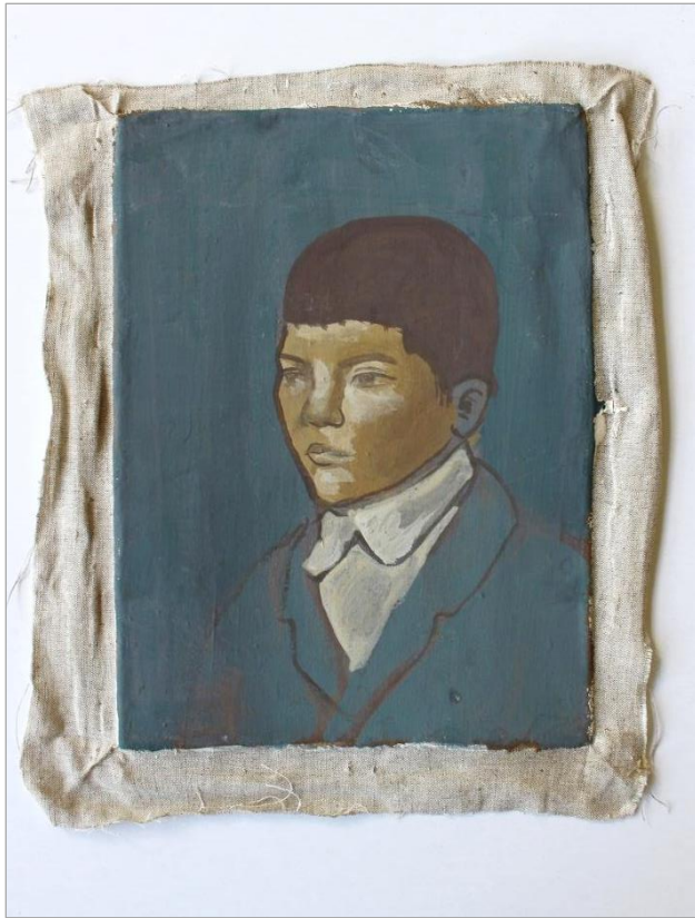
Slika br. 54 , lice simulacije slike „Dječak“ na koju je nanescna 5 i 10%-tna Beva 371 u white spiritu
