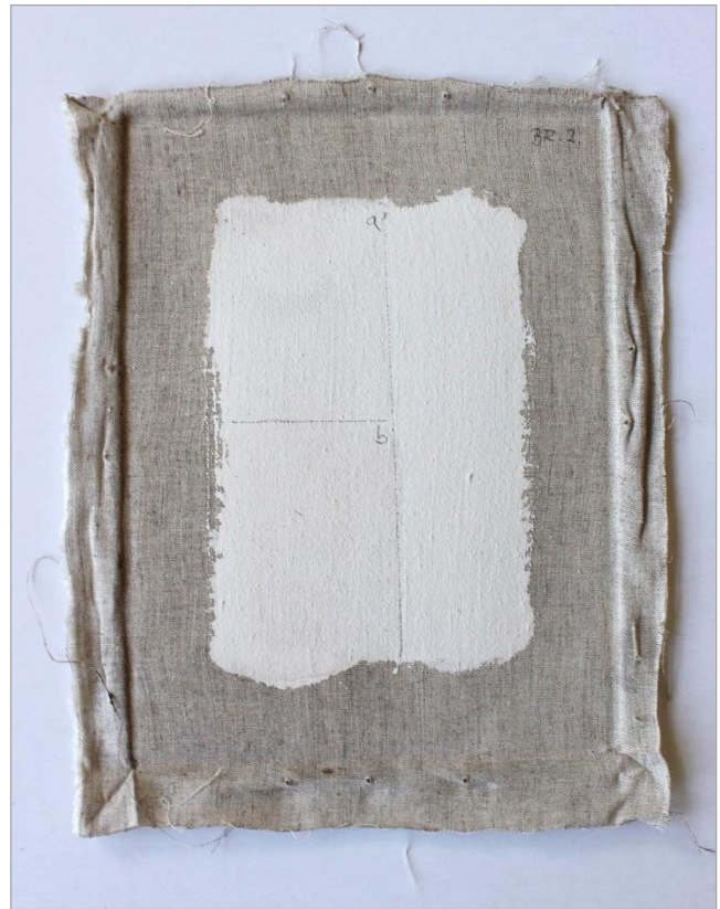
Slika br. 49 , poledina simulacije slike „Dječak“ na koju je nanesen 5 i 10%-tni Carboset 525 u etanolu
