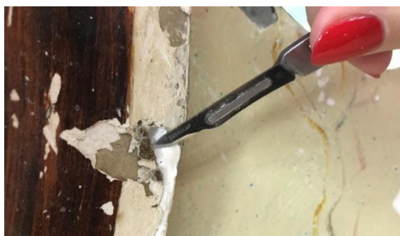
Slika 94. Uzimanje uzorka za FTIR analizu, preslik sa rubnog dijela postamenta, detalj, fotografirala Hana Knežević, 2019.
