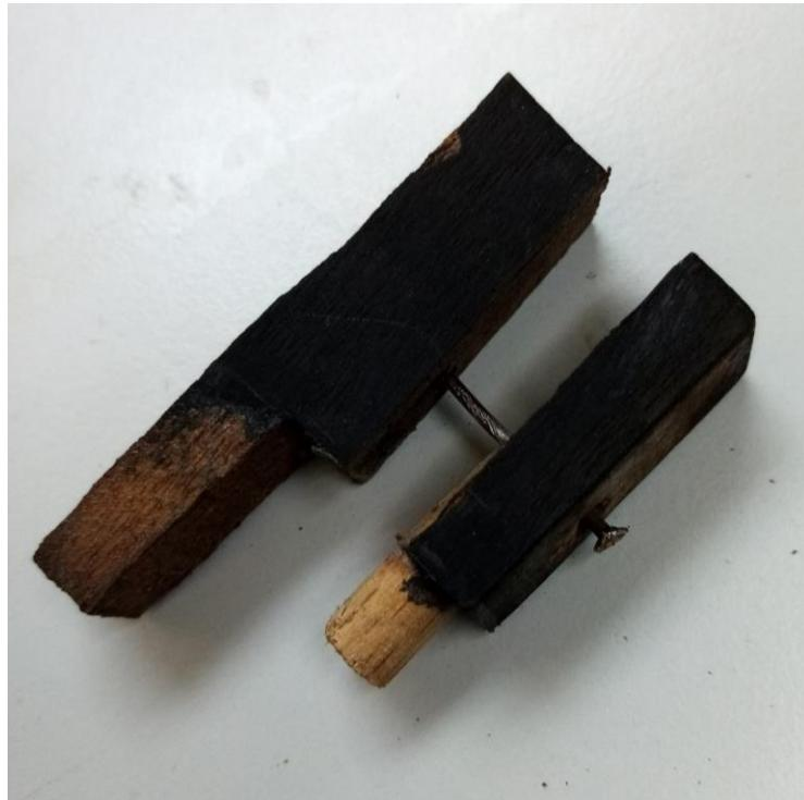
**Slika 33:** zatećeno stanje skulpture, prikaz oštećenja u sloju nosioca i prikaz industrijskog čavla zahvaćenog procesom korozije, fotografirala Sonja Pavin, Zagreb, 2020.
