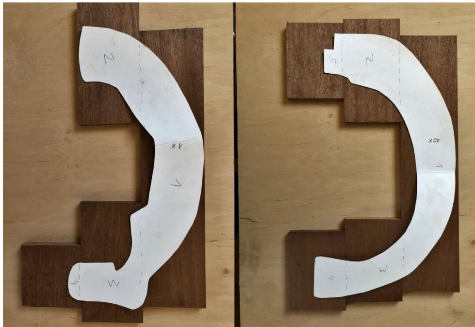
Slika 38: šablona po kojoj su rezani oblici letvica za rekonstrukciju skulpture, fotografirao Marko Rizvić, Nova Gradiška, 2020.
