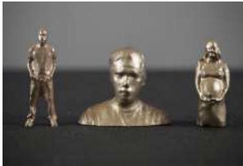
Slika 68: Primjer brončanog filameta
