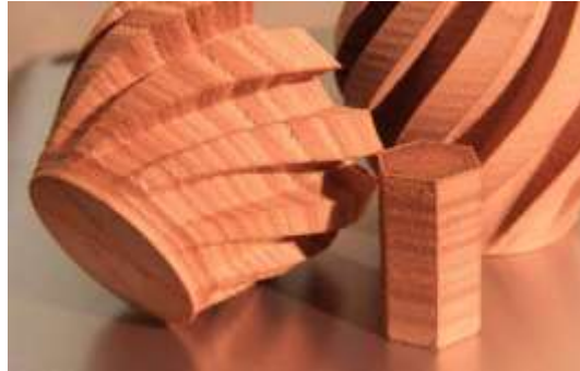
Slika 71: Primjer drvnog filameta
