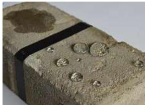
Slika 51: Primjer betona bez i sa super hidrofobom
