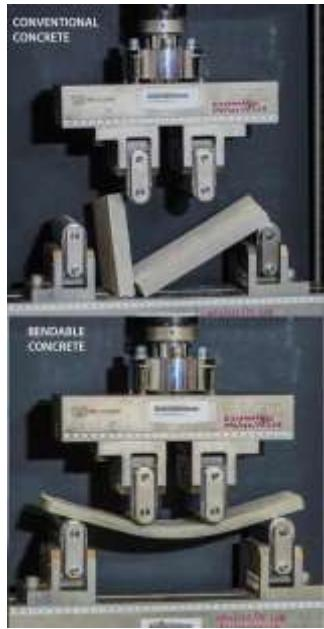
Slika 49: Usporedba tradicionalnog i savitljivog betona
