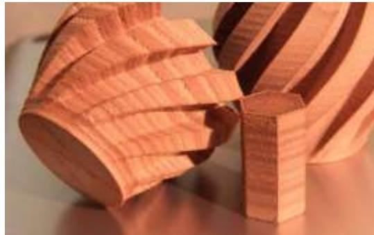
Slika 71: Primjer drvnog filamenta
