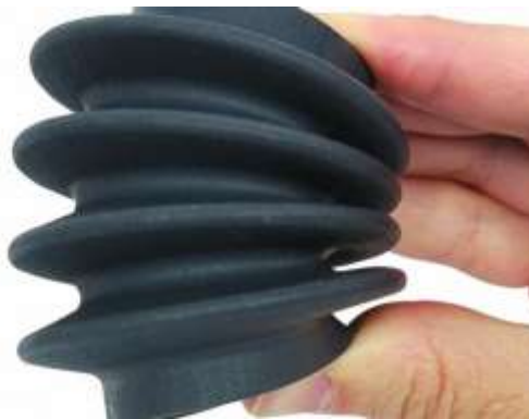
Slika 67: Primjer 3D ispisa TPE filamenta
