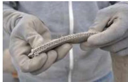
Slika 54: Presjek betonske tkanine
