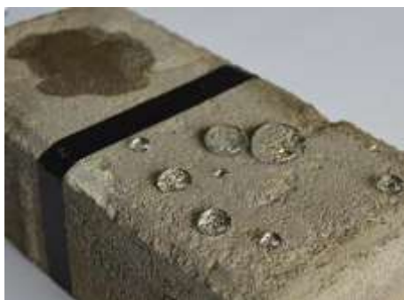
Slika 51: Primjer betona bez i sa super hidrofobom
