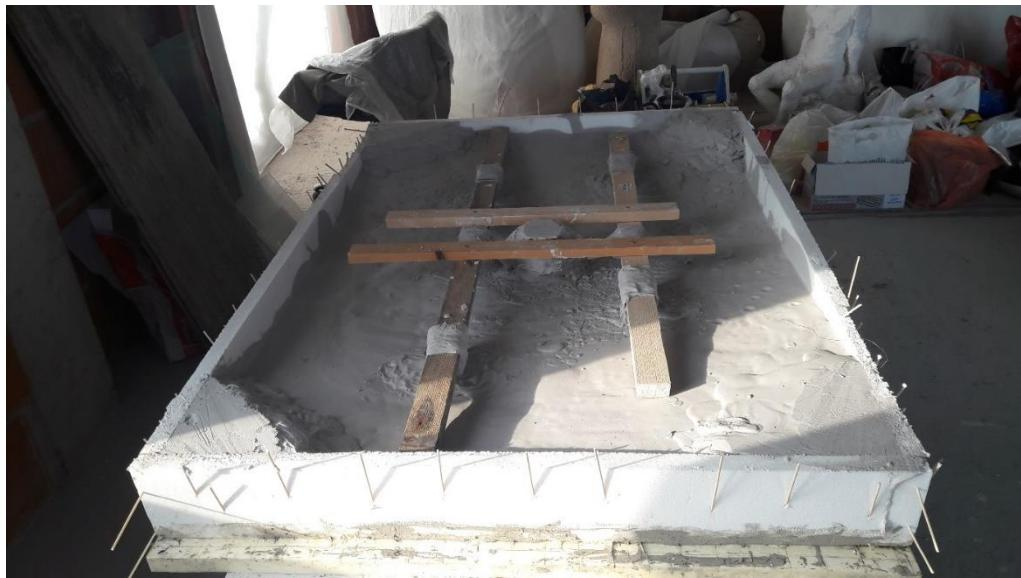
Sl. 19. Lijevanje gipsanog kalupa za papier-mâché
