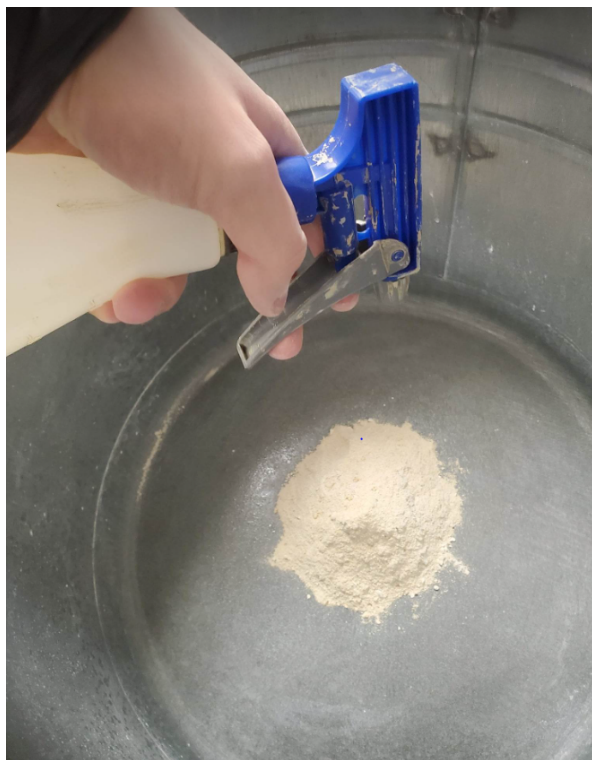
Slika 61. Proces gašenja hidrauličnog gašenog vapna. Snimio D. Pekić, 2022.
