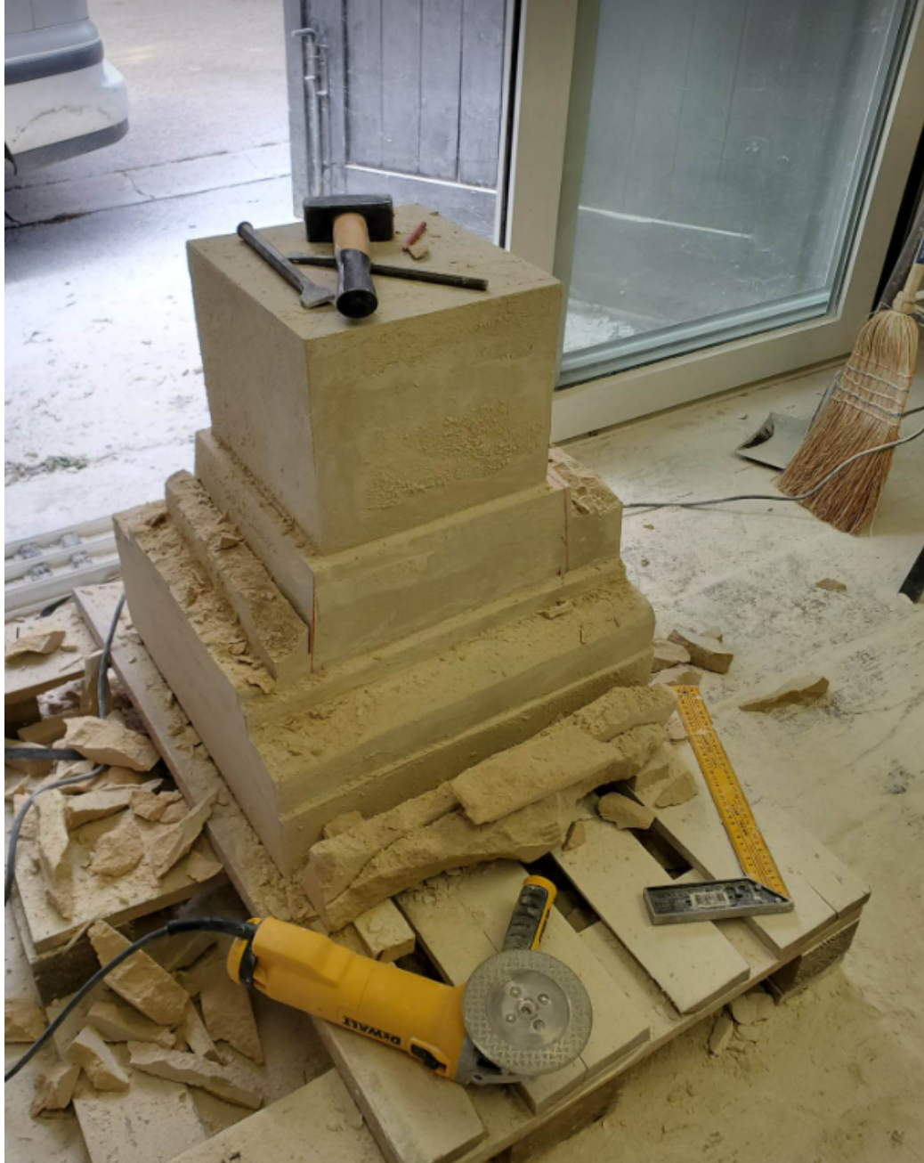
Slika 52. Prikaz skidanja viška kamene mase korištenjem strojnog alata. Snimio D. Pekić, 2022.
