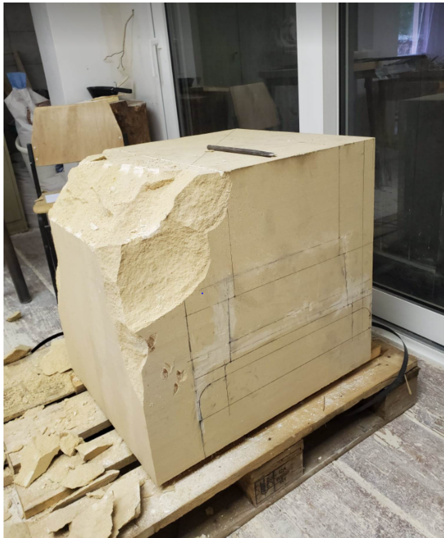
Slika 51. Prikaz tehničkog crteža prema kojem je klesano postolje. Snimio D. Pekić, 2022.
