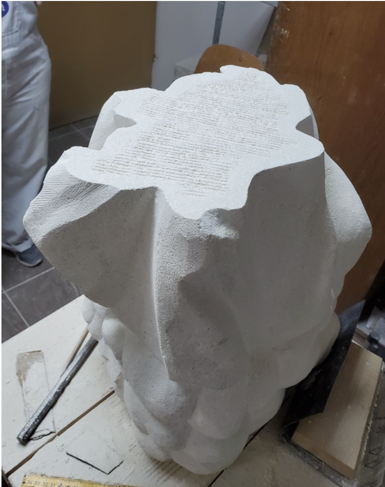
Slika 54. Prikaz obrađene plohe kamena zupčastim dlijetom na mjestu spajanja. Snimio D. Pekić, 2022.
