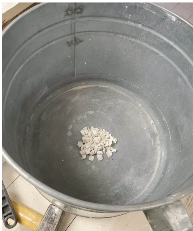
Slika 60. Prikaz hidrauličnog živog vapna neposredno pred gašenje. Snimio D. Pekić, 2022.
